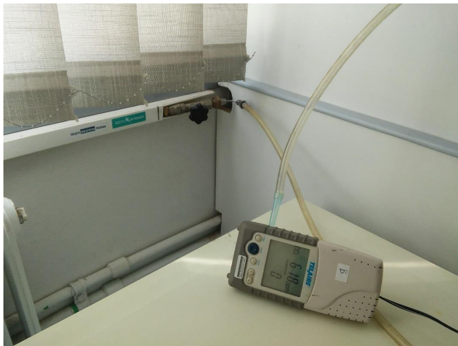
Εικόνα 4.3: Έγχυση αζώτου στο αισθητήριο Β
