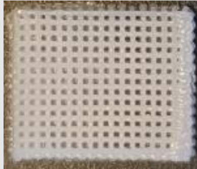
Εικόνα 4.18: Ικρίωμα 04 – κατασκευή για διαστασιολογικό έλεγχο.
