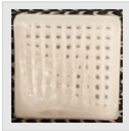
Εικόνα 4.30: Ικρίωμα 1 με ρύθμιση θερμοκρασίας εκτύπωσης 50 C°.
