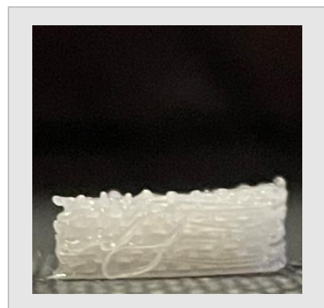
Εικόνα 4.36: Ικρίωμα 2 – πλευρική αλλοίωση του ικρίωματος.
