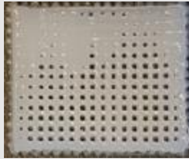
Εικόνα 4.12: Ικρίωμα 01 – κατασκευή για διαστασιολογικό έλεγχο.
