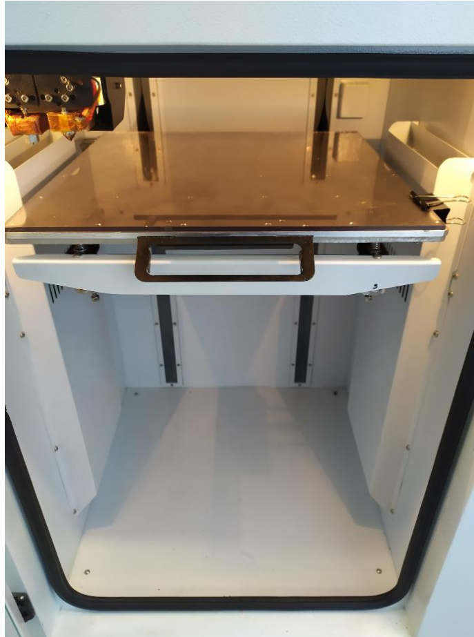
Εικόνα 4.6: Το γυάλινο κρεβάτι εγκατεστημένο στην πλατφόρμα του εκτυπωτή.
