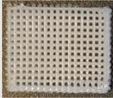
Εικόνα 4.16: Ικρίωμα 03 – κατασκευή για διαστασιολογικό έλεγχο.
