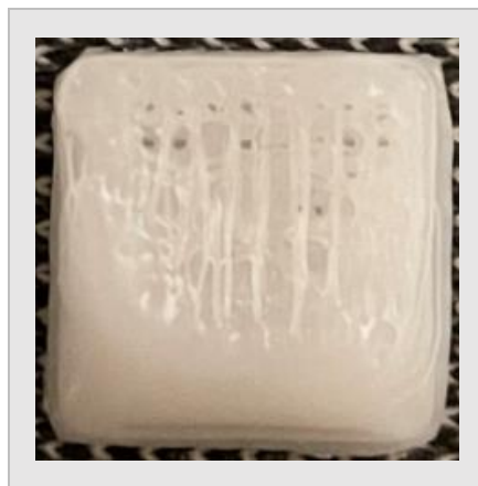
Εικόνα 4.29: ημι-τελές ικρίωμα - Παρουσιάζει αλλοιωμένη γεωμετρία.
