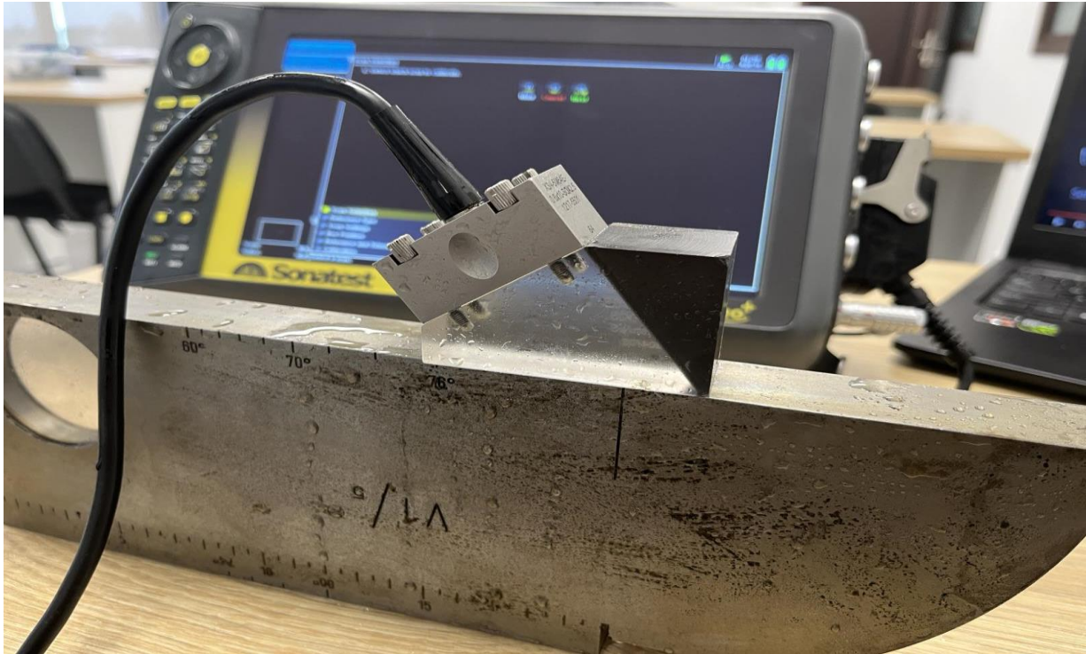
Εικόνα 6.2.3.1: Τοποθέτηση κεφαλής στο δοκίμιο για βαθμονόμηση καθυστέρησης σφήνας.
