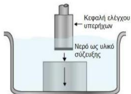
Εικόνα 2.4.1: Έλεγχος με τεχνική εμβάπτισης [33].
