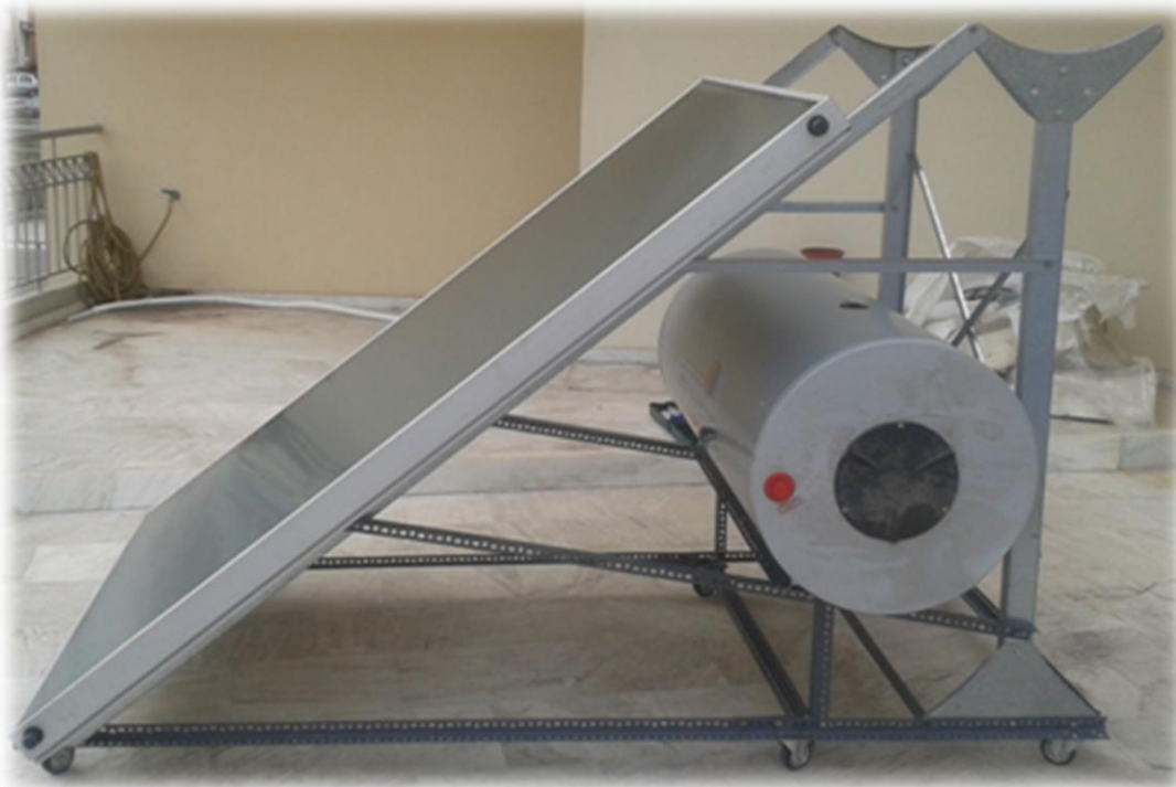
Εικόνα 3.18: Πλάγια δεξιά όψη της πειραματικής διάταξης μετά την τοποθέτηση της δεξαμενής αποθήκευσης και του ηλιακού συλλέκτη.
