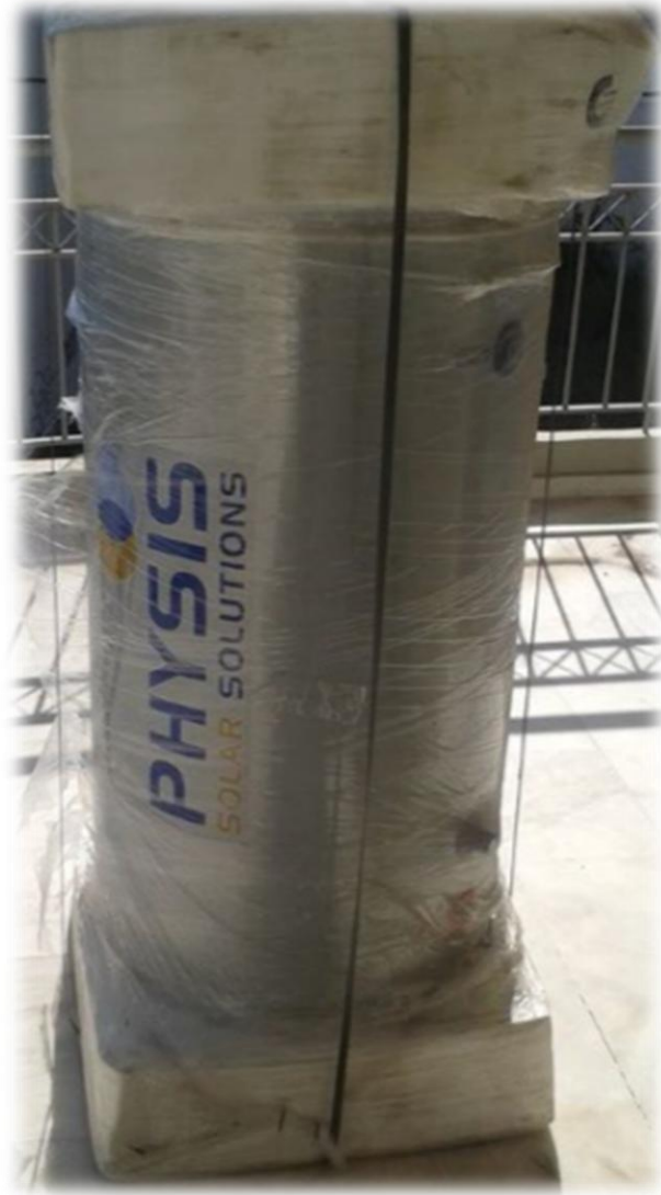
Εικόνα 3.47: Δεξαμενη αποθήκευσης PHYSIS solar solution.
