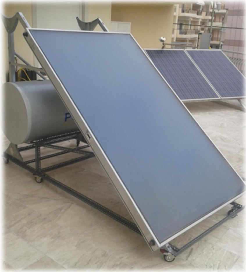
Εικόνα 3.17: Μπροστινή όψη της πειραματικής διάταξης μετά την τοποθέτηση της δεξαμενής αποθήκευσης και του ηλιακού συλλέκτη.
