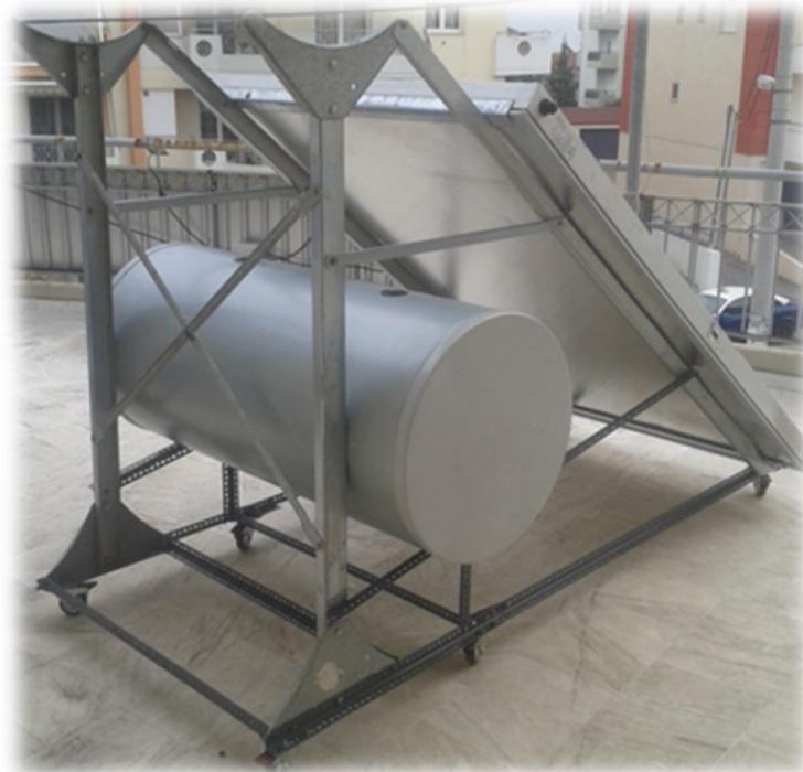
Εικόνα 3.20: Πίσω όψη της πειραματικής διάταξης μετά την τοποθέτηση της δεξαμενής αποθήκευσης και του ηλιακού συλλέκτη.
