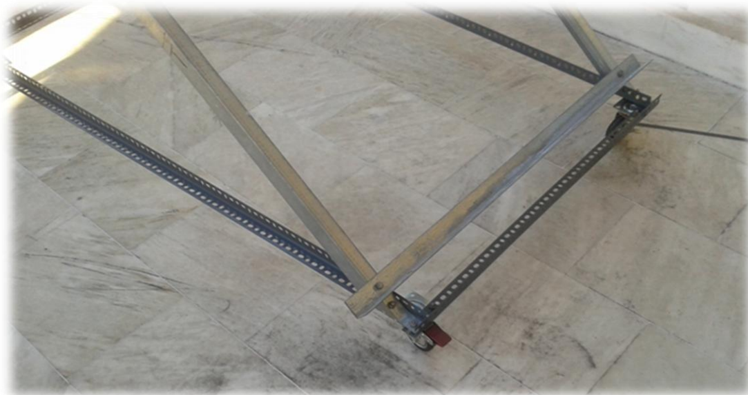
Εικόνα 3.10: Τοποθέτηση τροχών στο αμάξωμα.
