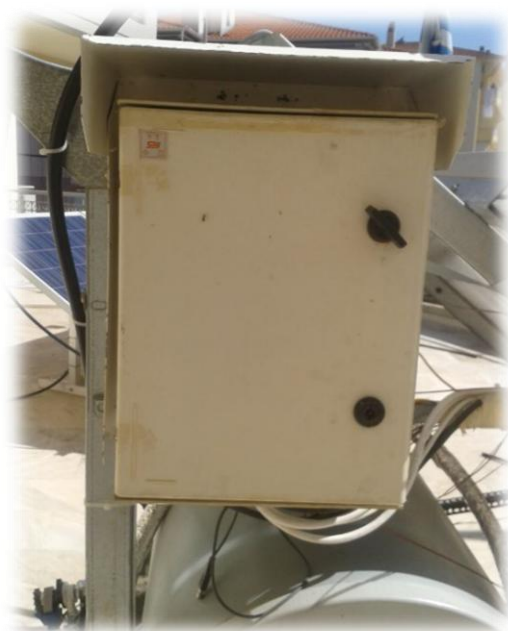
Εικόνα 3.59: Βασική μονάδα Data Logger (CR1000) τοποθετημένη στην βάση στήριξης της πειραματικής διάταξης.
