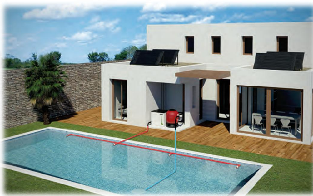
Εικόνα 1.2: Θέρμανση πισίνας με ηλιακούς συλλέκτες χωρίς διαφανές κάλυμμα.[6]
