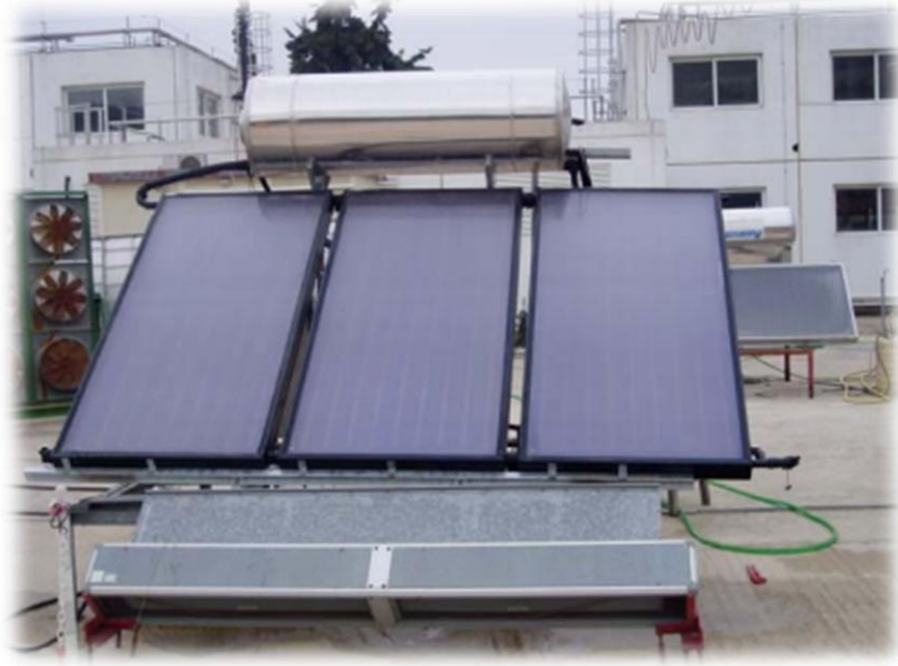
Εικόνα 2.3: Εγκατάσταση δοκιμών οικιακών ηλιακών συστημάτων στο εργαστήριο.[18]
