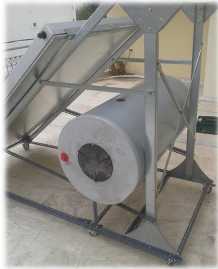
Εικόνα 3.19: Πίσω δεξιά όψη της πειραματικής διάταξης μετά την τοποθέτηση της δεξαμενής αποθήκευσης και του ηλιακού συλλέκτη.
