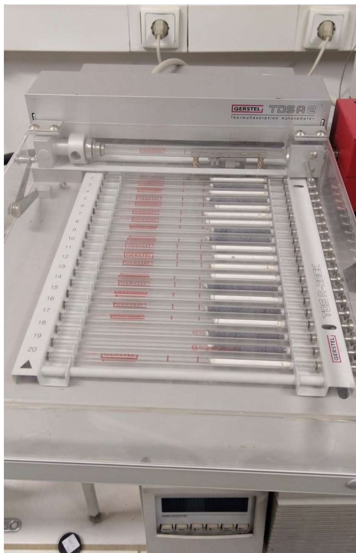
Εικόνα 3.11: Κασετίνα εισαγωγής των δειγμάτων tenax στο χρωματογράφο μάζας GC – MS
