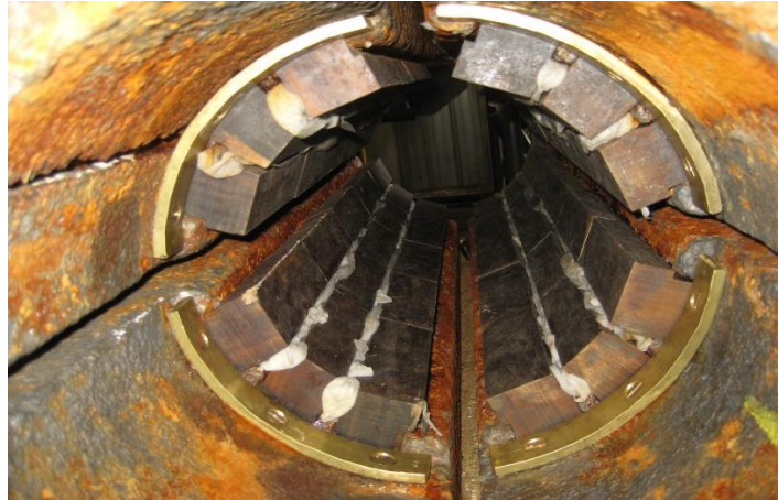
Εικόνα 2.4.3.1: Πρυμναίος σωλήνας από ξύλο lignum vitae «δέντρο της ζωής». ( Lignum Vitae | Wood Bearings , n.d.)
