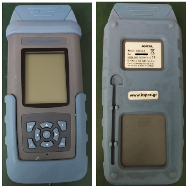
Εικόνα 33. Εξοπλισμός/Εργαλεία 10: Μετρητής/Πολύμετρο οπτικής ίνας
