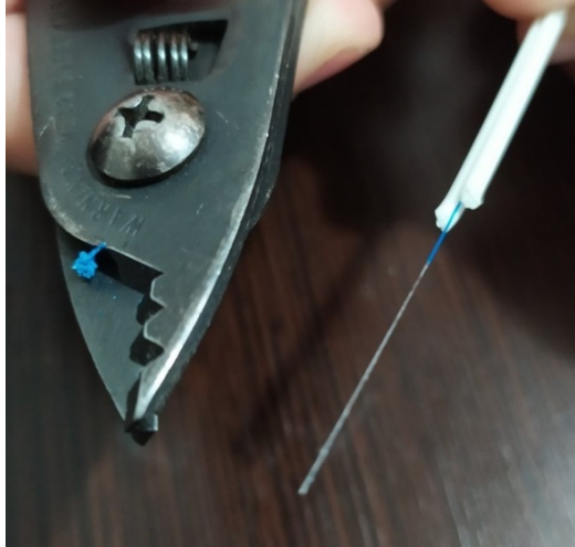
Εικόνα 42. Βήματα κόλλησης 3: Οπτική ίνα τρίτο στάδιο
