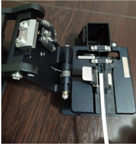
Εικόνα 44. Βήματα κόλλησης 5: Κόπτης με οπτική ίνα
