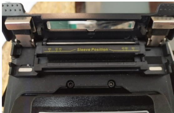
Εικόνα 31. Εξοπλισμός/Εργαλεία 8: Συγκολλητής Splicer οπτικής ίνας
