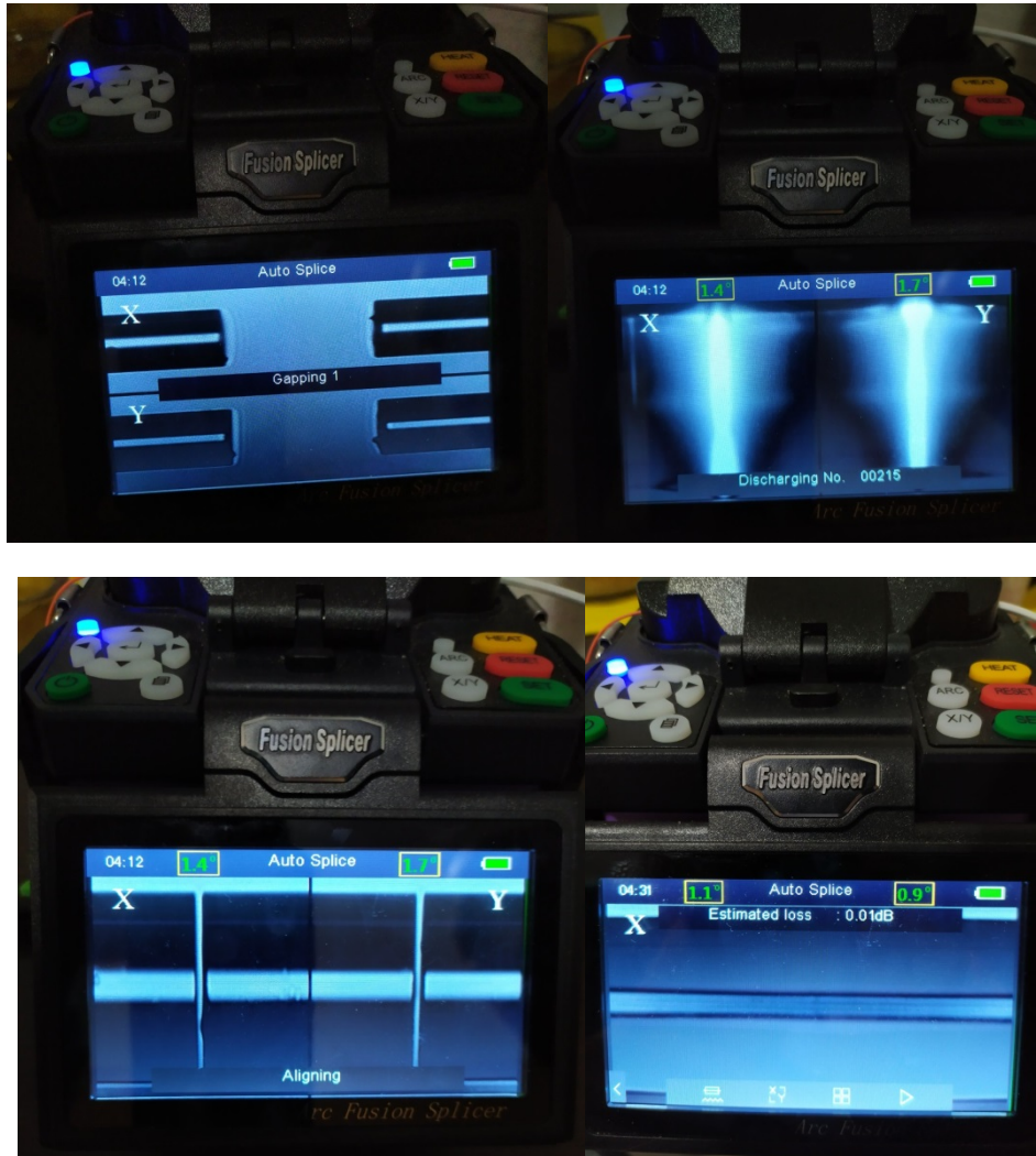
Εικόνα 46. Βήματα κόλλησης 7: Επιτυχής κόλληση οπτικής ίνας με συνδετήρα
