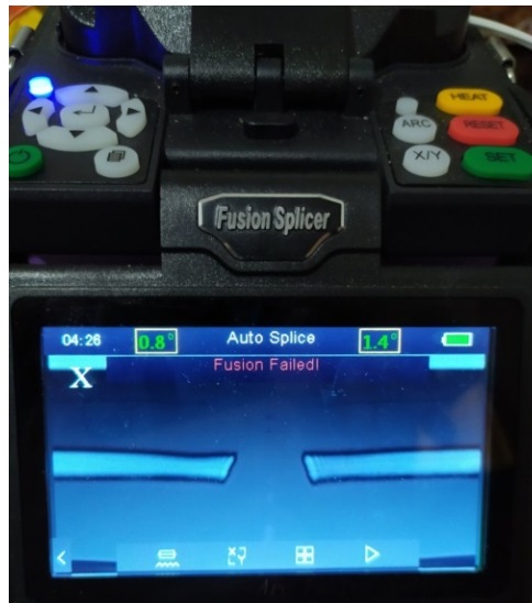
Εικόνα 48. Βήματα κόλλησης 9: Σφάλμα συγκολλητή Fusion Failed
