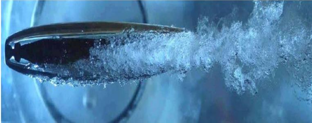
Εικόνα 13-Φαινόμενο υπερσπηλαίωσης. ΠΗΓΗ: " https://maredu.hcg.gr/modules/document/file.php/MAK212/Μηχανική Ρευστών/ΦΑΙΝΟΜΕΝΟ_ΥΠΕΡΣΠΗΛΑΙΩΣΗΣ.pdf "
