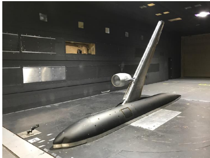
Εικόνα 18 Φωτογραφία του μοντέλου δοκιμών του αεροσκάφους CRM, με το οποίο έγιναν οι πειραματικές μετρήσεις (Lin, et al., 2022)
