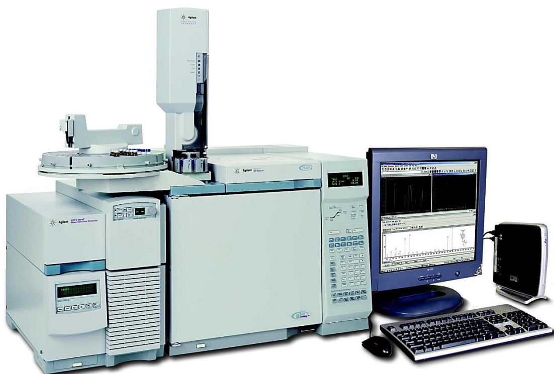
Σχήμα 4.3: Ο αέριος χρωματογράφος – φασματογράφος μάζας Agilent 6890n/5973
