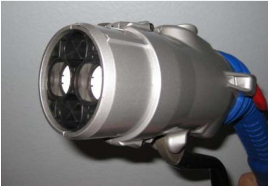
Εικόνα 14. Ρευματολήπτης (βύσμα) συνεχούς ρεύματος επιπέδου 2 τύπου CHAdeMO (Πηγή: Briones et al., 2012).
