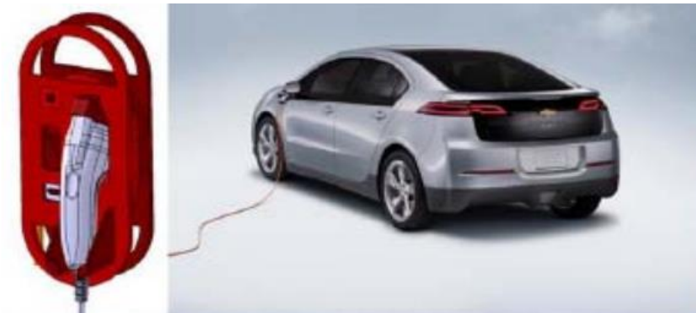
Εικόνα 7. Σετ καλωδίου επιπέδου 1 εναλλασσόμενου ρεύματος
