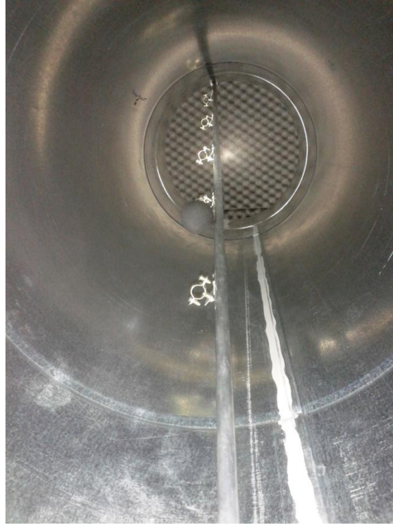
Σχήμα E.11: Κυκλικός αγωγός μετρήσεων χωρίς ροή {7}
