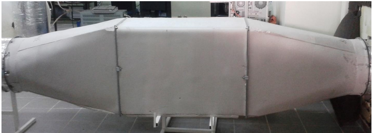
Σχήμα E.10: Ηχοπαγίδα ενσωματωμένη με τους αγωγούς συστολής και διαστολής {7}
