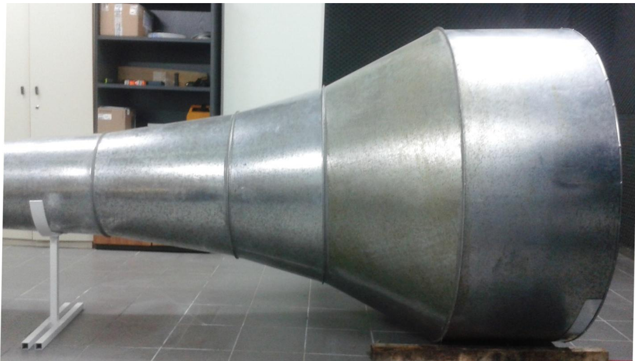
Σχήμα E.13: Εξωτερική όψη ανηχοϊκή σήραγγα {7}
