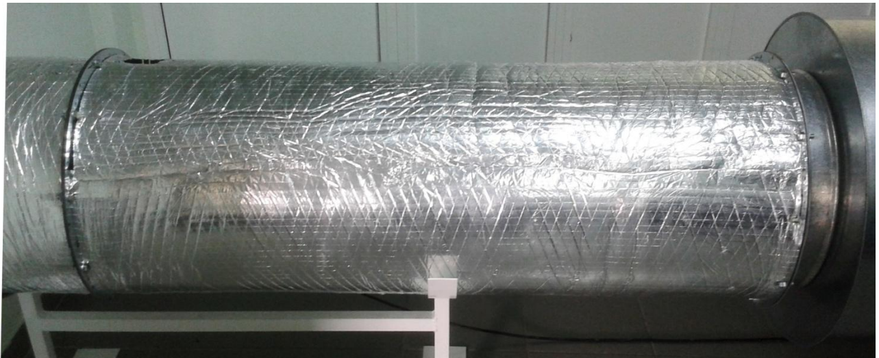
Σχήμα E.6: Κοκλικής διατομής αγωγός ομαλοποίησης της ροής {7}
