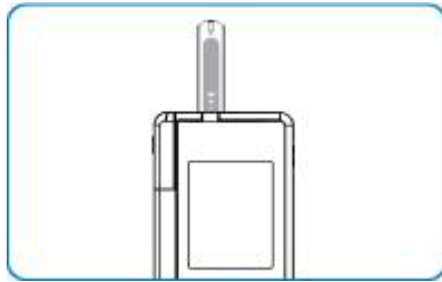
1.Είσοδος ταινίας μέτρησης στον μετρητή
