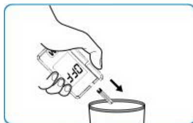
6.Εξαγωγή της ταινίας μέτρησης από το μηχανήμα
