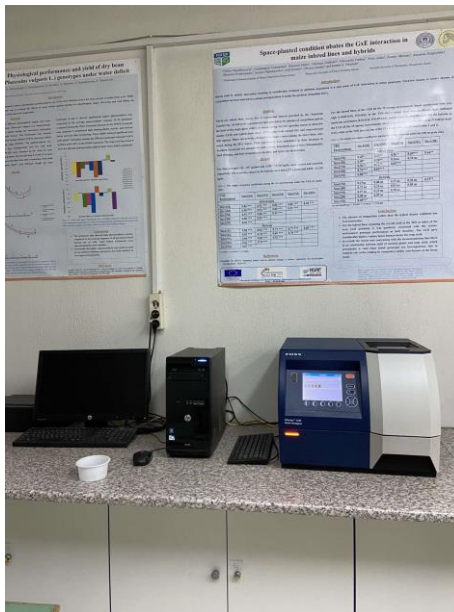
Εικόνα 2.5: Μηχάνημα INFRATEC 1241 ποιοτικών αναλύσεων δειγμάτων σπόρων
