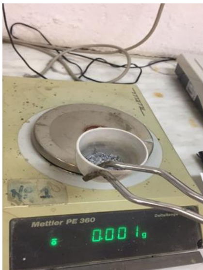
Εικόνα 27: Τελική μορφή αποτεφρωμένου δείγματος
