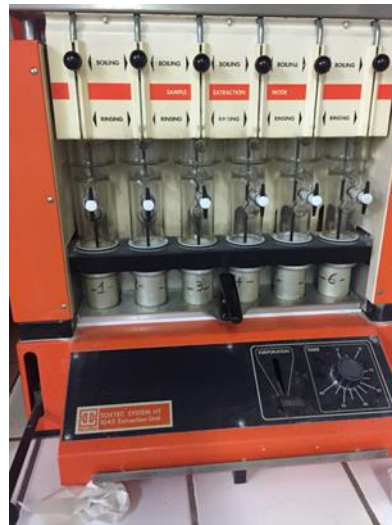
Εικόνα 28: Συσκευή εκχύλισης Soxhlet
