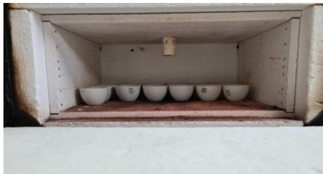
Εικόνα 26: Τοποθέτηση χωνευτηρίων στον κλίβανο
