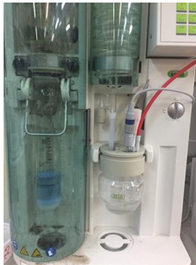
Εικόνα 29: Συσκευή καύσης Kjeldahl-Λευκός προσδιορισμός
