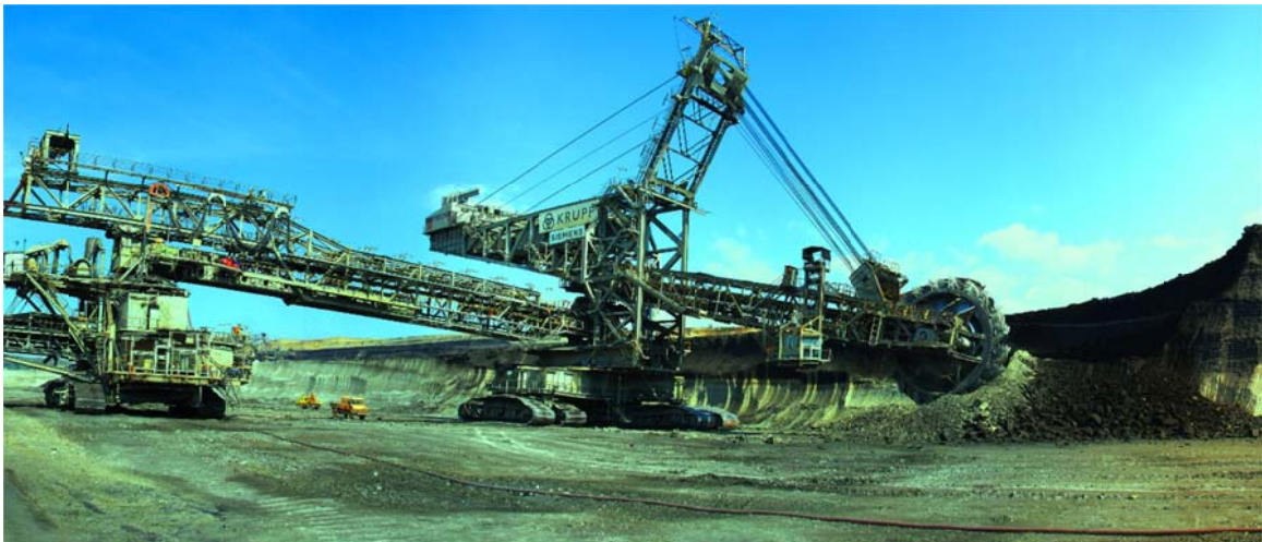
Εικόνα 3 . 7 . Η διαδικασία στρωματοποιημένης επιφανειακής εξόρυξης λιγνίτη με καδοφόρους εκσκαφείς
