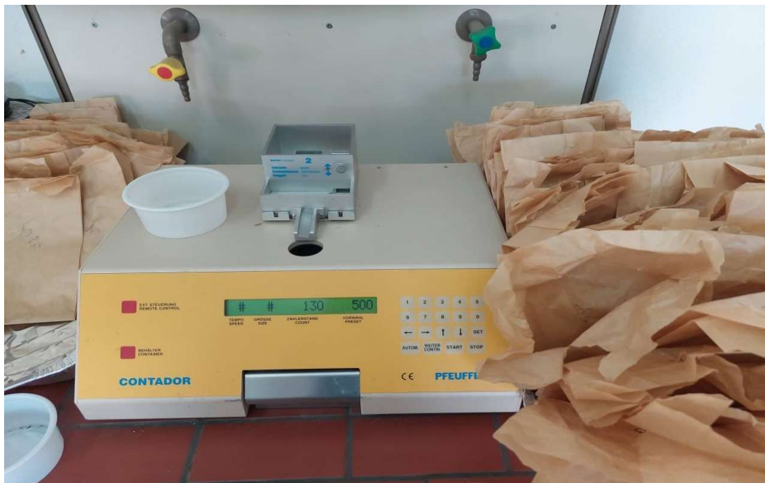
Εικόνα 29. Συσκευή Contador του Γερμανικού Οίκου Pfeuffer για ακριβή μέτρηση 1000 κόκκων σιτηρών διαστάσεων από 0,3 έως 15 χιλ.
