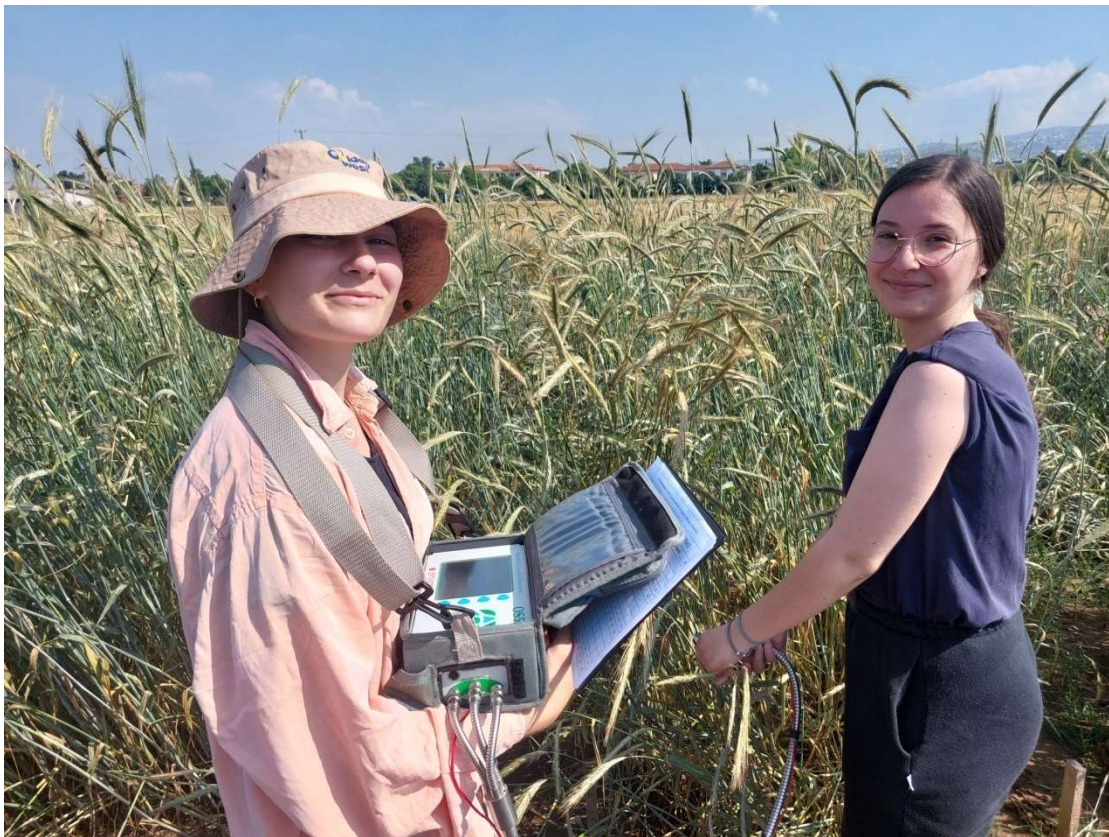
Εικόνα 31. Μέτρηση φθορισμού της χλωροφύλλης με το φορητό σύστημα OPTI SCIENCES OS5p
