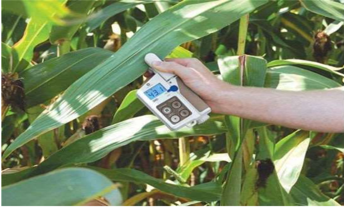
Εικόνα 30. Φορητό όργανο SPAD 52 PLUS για μέτρηση της περιεκτικότητας χλωροφύλλης.
