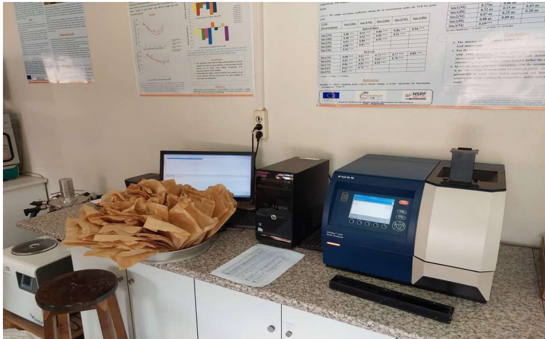
Εικόνα 28. Όργανο Infratec TM 1241 Grain Analyzer FOSS για μέτρηση περιεκτικότητας πρωτεΐνης και υγρασίας κατάλληλο για μικρές ποσότητες δείγματος
