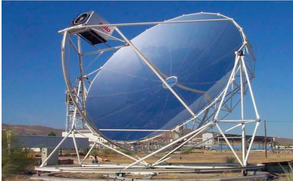
Σχήμα 2.15 Ηλιακός συλλέκτης παραβολικού δίσκου με απευθείας συνδεδεμένη μηχανή για παραγωγή έργου ( ecowanderer.wordpress.com )
