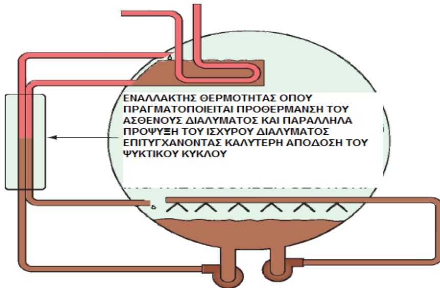
Σχήμα 4.11 Εναλλάκτης θερμότητας μεταξύ του ασθενούς και του ισχυρού διαλύματος (Andrew D. Atihouse, C. H. (2004). Modern Refrigeration and Air Conditioning .)
