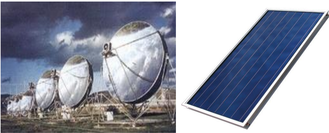
Σχήμα 2.2 Σειρά συγκεντρωτικών ηλιακών συλλεκτών (αριστερά) ( www.volker-quaschnig.de ) - Μη συγκεντρωτικός ηλιακός συλλέκτης (δεξιά) ( www.helioakmi.com )
