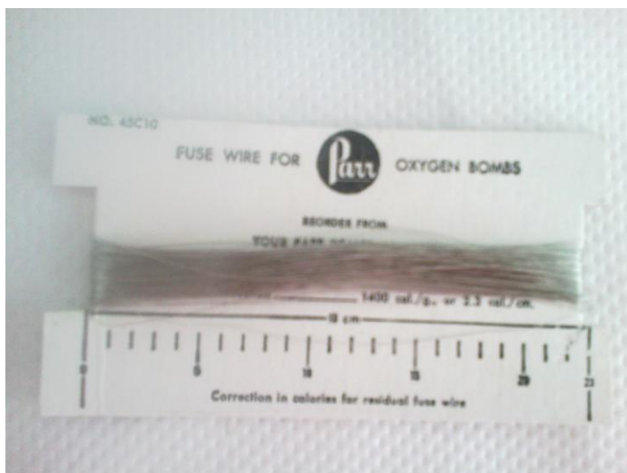
Εικόνα 2.4: Σύρμα «45C10 FUSE WIRE» που χρησιμοποιείται για την έναυση του καυσίμου
