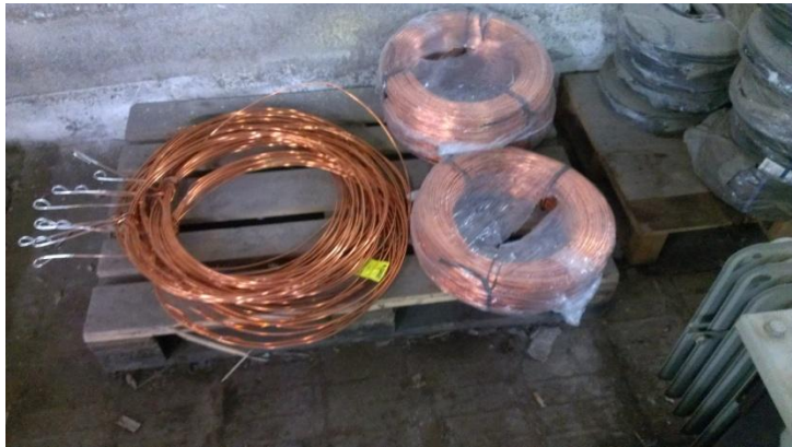
Φωτογραφία 4.5 Αγωγός Cu Φ16
