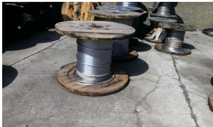
Φωτογραφία 4.6 Αγωγός ACSR95
