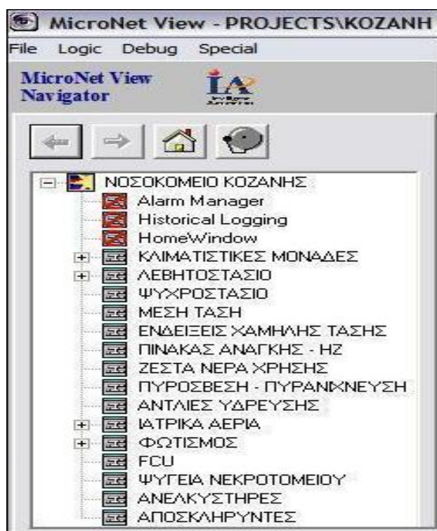
Εικόνα 7.3: Η/Μ που ελέγχει το BMS
