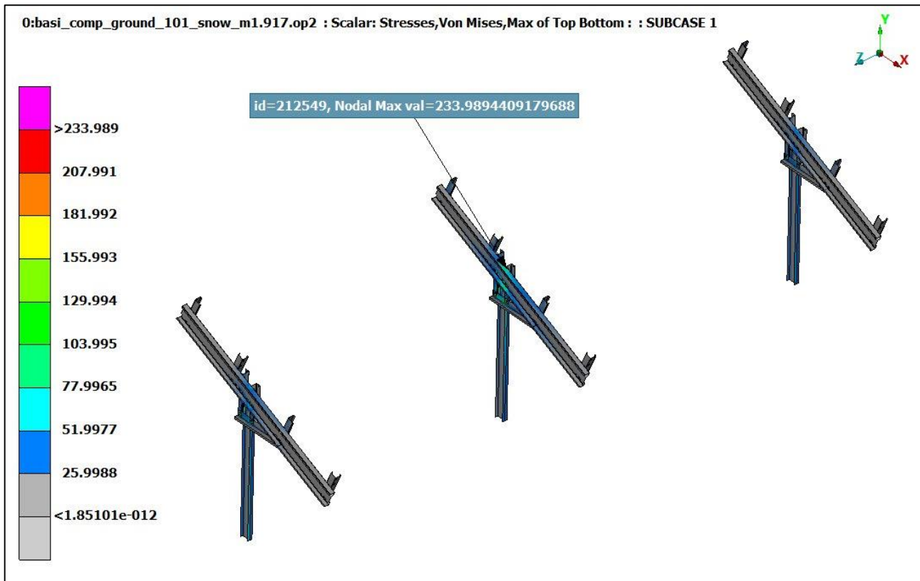
Σχήμα 6.2.1.5 Μέγιστη εφαρμοζόμενη πίεση χιονιού στα τρία κάθετα στηρίγματα
