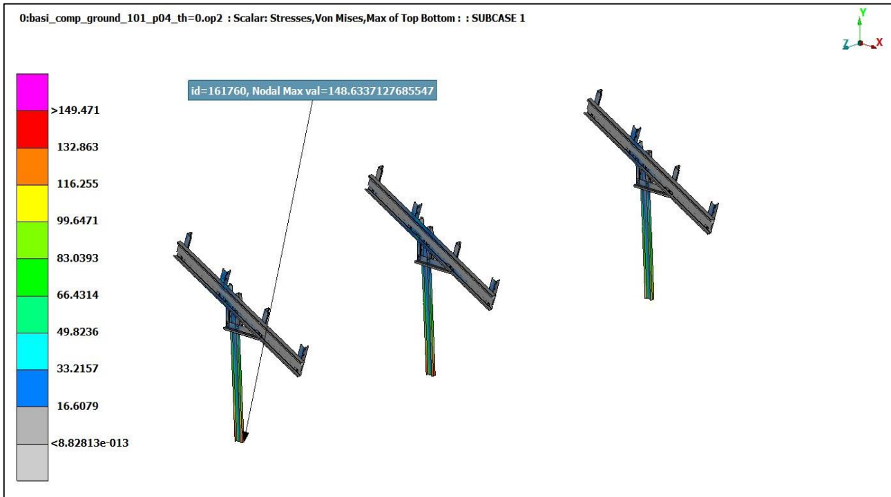
Σχήμα 6.2.2.4 Μέγιστη εφαρμοζόμενη πίεση ανέμου για \theta=0^\circ στα τρία κάθετα στηρίγματα
