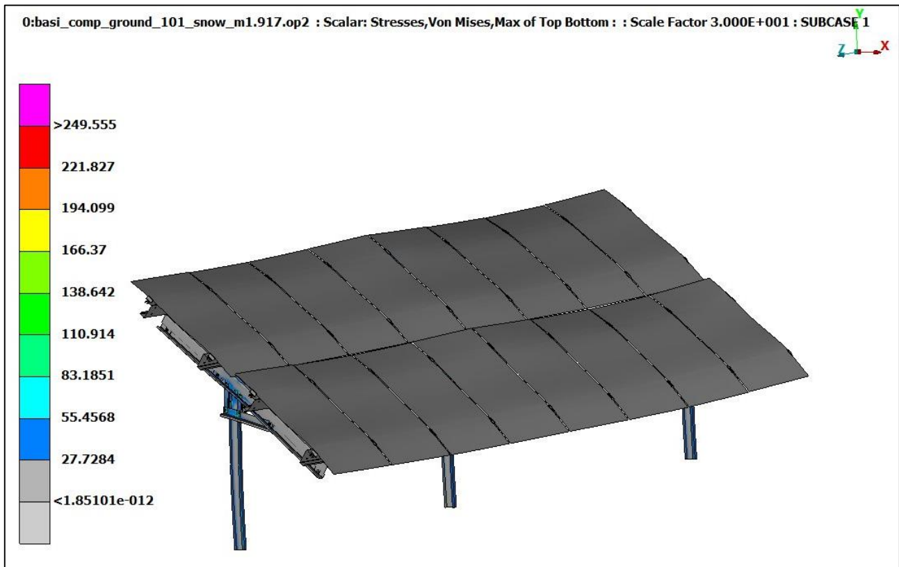
Σχήμα 6.2.1.2 Παραμόρφωση λόγω χιονιού σε μεγέθυνση x30
