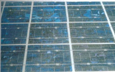
Σχήμα 2.4.2.: Φωτοβολταϊκή επιφάνεια από πολυκρυσταλλικό πυρίτιο. Πηγή: ΜΠΑΛΑΡΑΣ Κ.Α., 2002.
