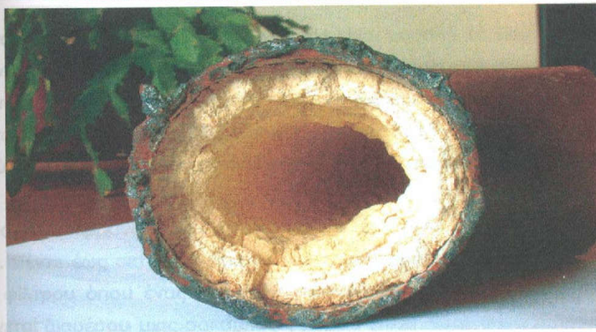
Σχήμα 5-1 . Αποφλοιώση του σωλήνα τηλεθέρμανσης λόγω της πλήρωσής του με ακατέργαστο νερό (Kristensen, 2002).
