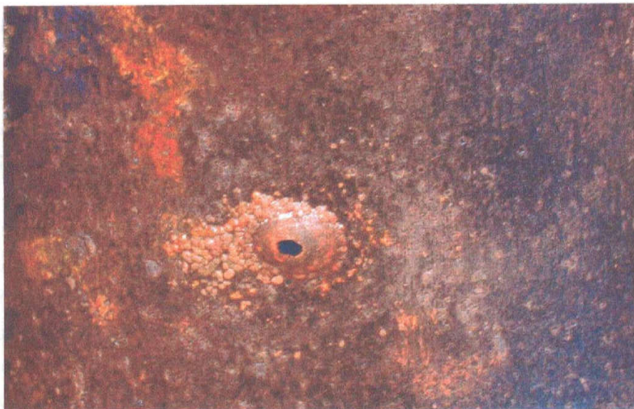
Σχήμα 5-4 . Διάβρωση προκαλούμενη από το κατακάθι χαλκού σε συνδυασμό με το οξυγόνο, την πολύ χαμηλή κυκλοφορία και τη λήψη στον σωλήνα (Kristensen, 2002).
