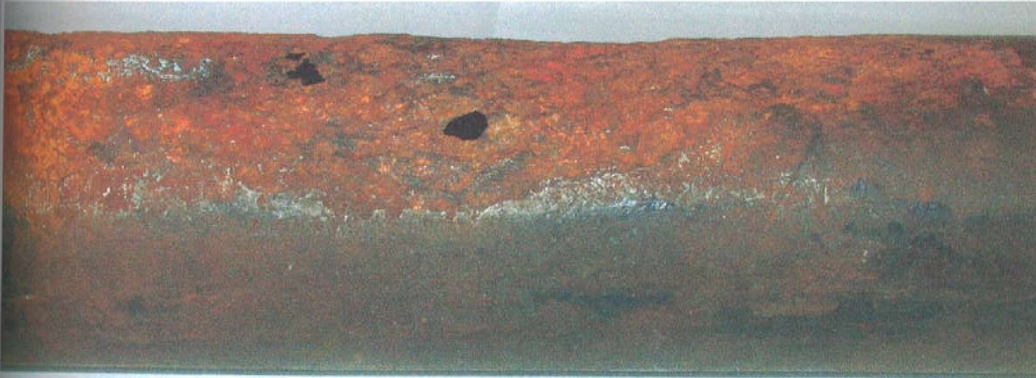
Σχήμα 5-5 . Διάβρωση σε σωλήνες κυκλοφορίας ατμού προκαλούμενη από μικροβιολογική επίθεση (Kristensen, 2002).
