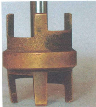
Σχήμα 5-3 . Έκπλιση του μορίου ψευδαργύρου από τον ορείχαλκο λόγω της υψηλής τιμής του PH (Kristensen, 2002).
