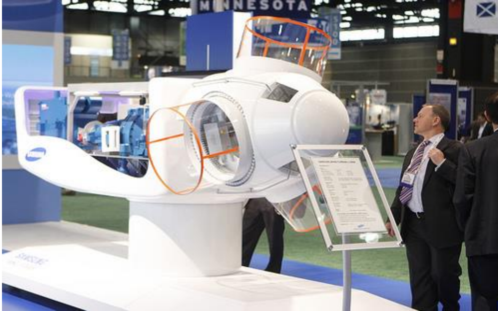
Εικόνα 29: φωτογραφία που απεικονίζει την βάση των πτερυγίων και την πλύμνη αλλά και μεγάλο μέρος του σώματος της ανεμογεννήτριας.
