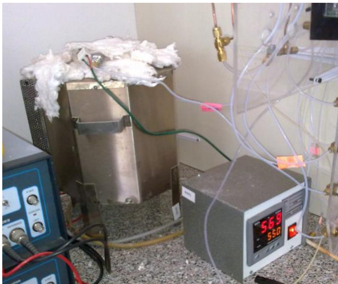
Σχήμα 4.2: Θερμορυθμιστής (πάνω, τρέχουσα θεροκρασία, κάτω, επιθυμητή)
