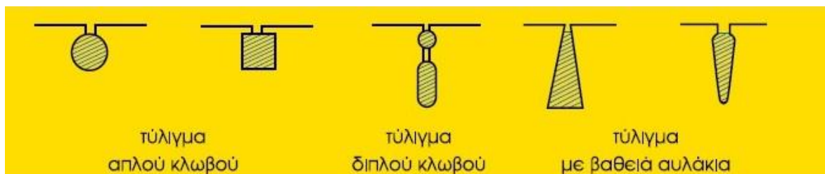
Εικόνα 1.3. Τύποι αυλακώσεων ελασμάτων [3].
