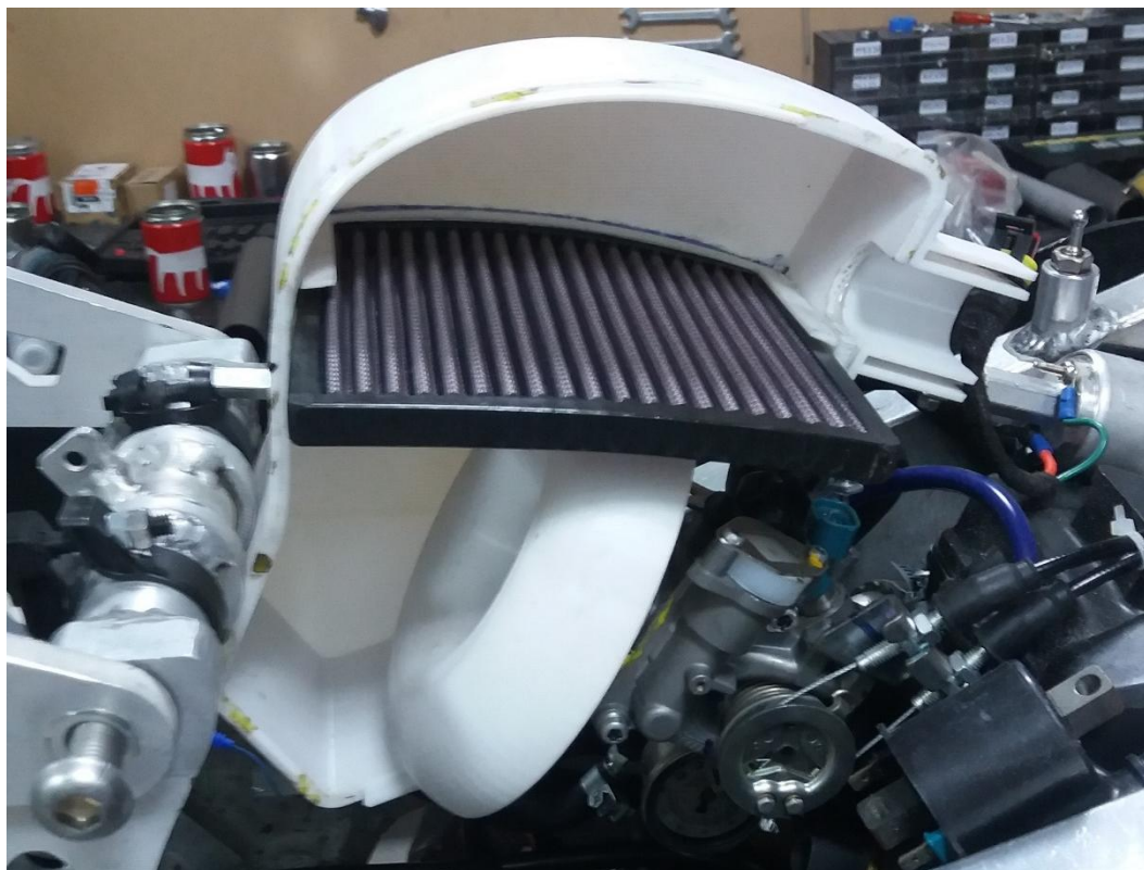
Εικόνα 4.3 – Θάλαμος plenum σε πλάγια τομή
