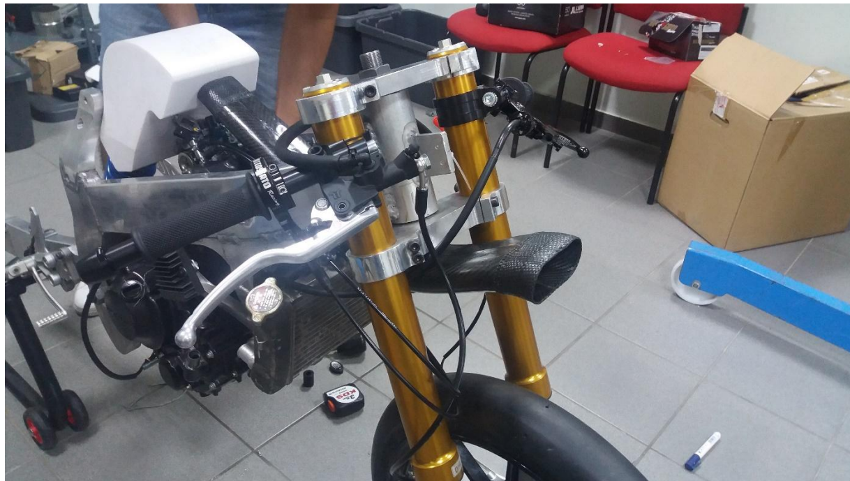
Εικόνα 4.4 – Εφαρμογή της διάταξης εισαγωγής πάνω στην μοτοσυκλέτα
