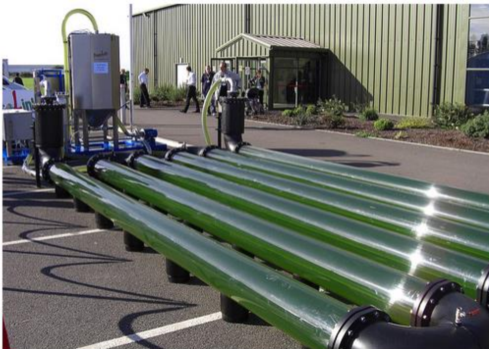
Σχήμα 5: Σύστημα κλειστών σωληνοειδών φωτοβιοαντιδραστήρων
