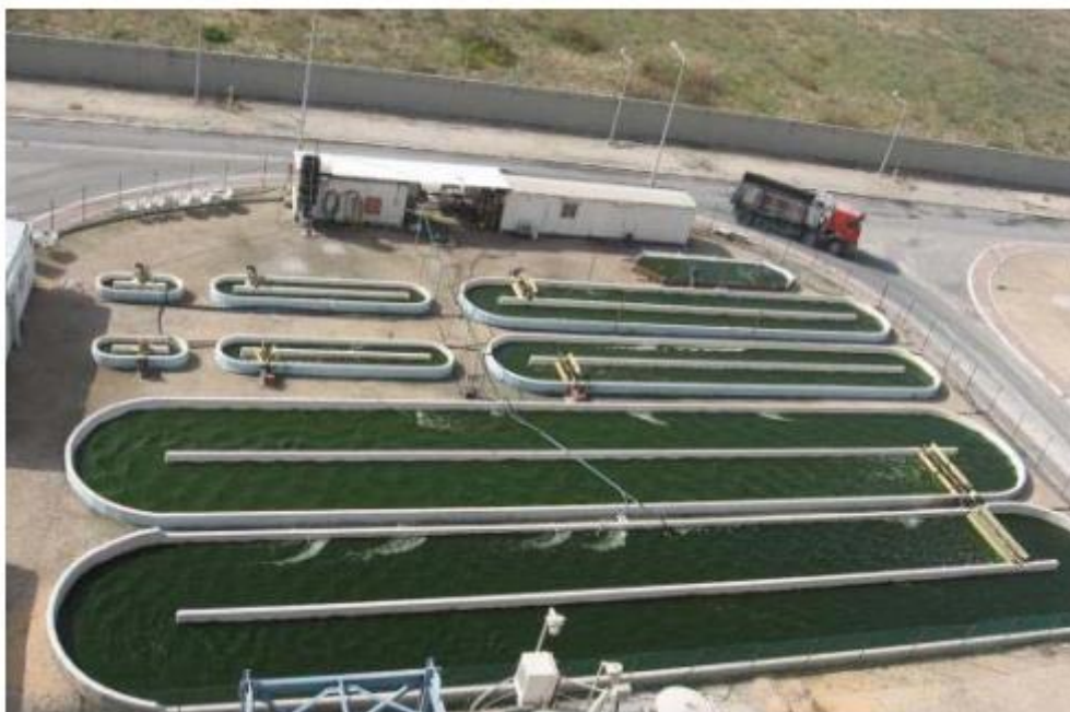
Σχήμα 4: Εργοστάσιο παραγωγής μικροάλγης που λειτουργεί με συστήματα ανοιχτής αυλακοειδούς λίμνης
