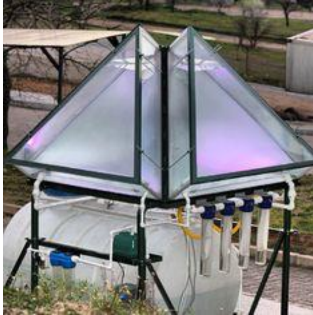
Σχήμα 31: Φωτοβιοαντιδραστήρας για καλλιέργεια μικροάλγης τύπου πυραμίδας
