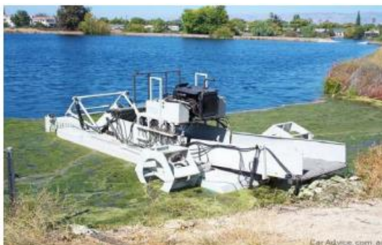
Σχήμα 15: Μηχάνημα διαχωρισμού της άλγης σε μορφή αφρού από την επιφάνεια της θάλασσας
