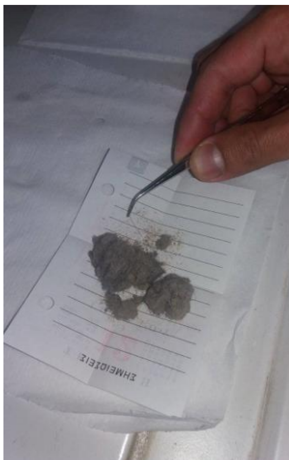
Σχήμα 19. Απομάκρυνση τριχών και σωματιδίων από το δείγμα
