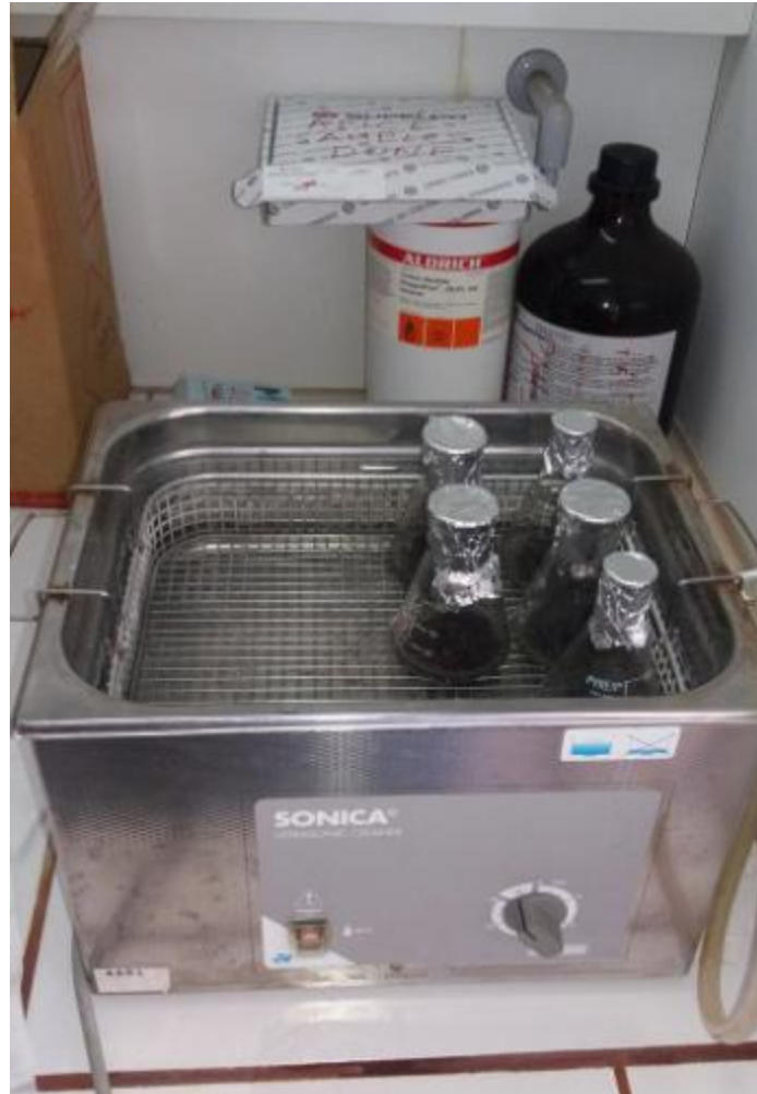
Σχήμα 21. Μέθοδος εκχύλισης των δειγμάτων σκόνης
