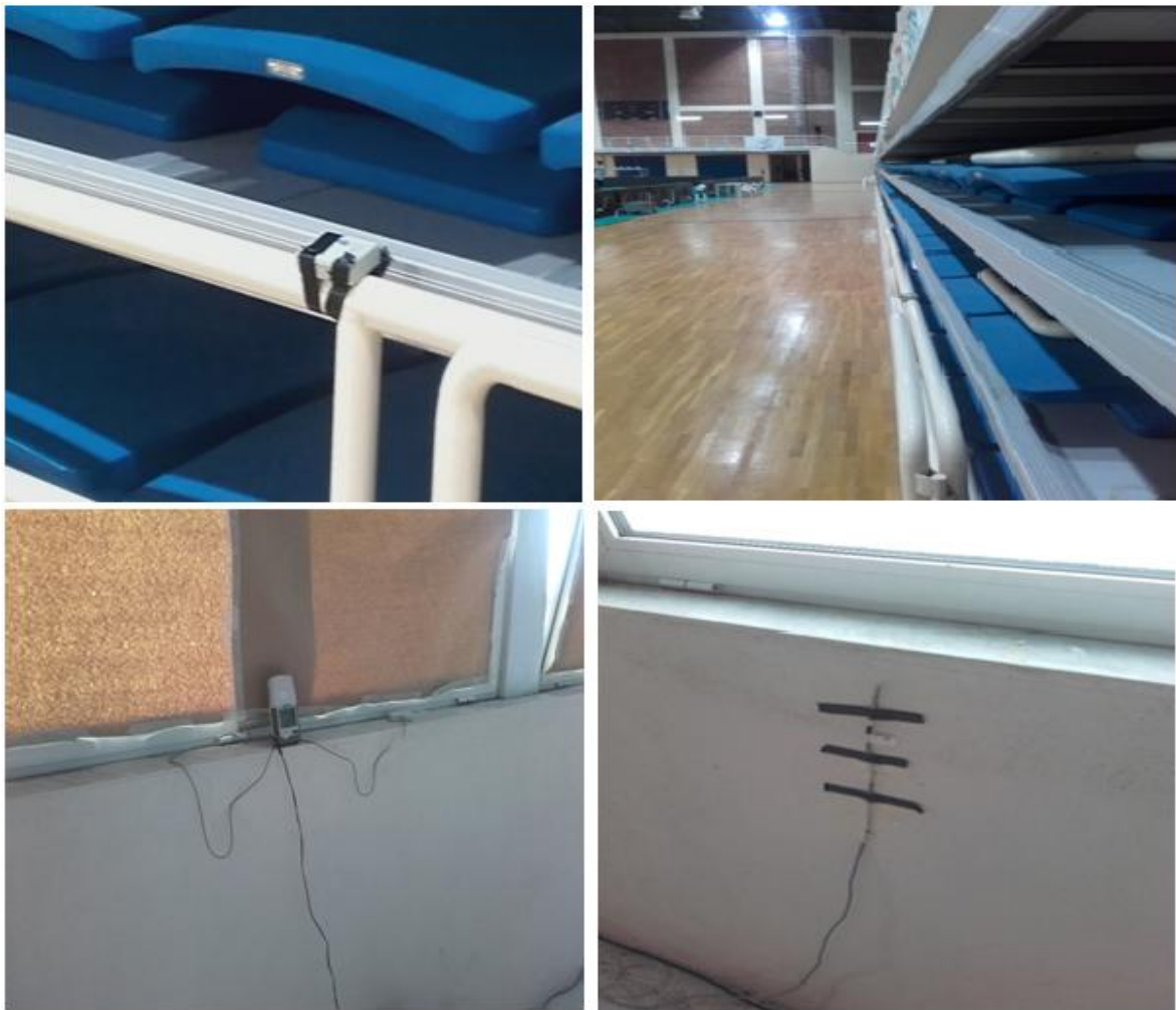
Σχήμα 4. 11: Φωτογραφικό υλικό από τον αισθητήρα Hobo 2 σε κοντινή και γενική άποψη πάνω αριστερά και δεξιά, αισθητήρα Hobo C κάτω αριστερά και επιφανειακό θερμομέτρο κάτω δεξιά
