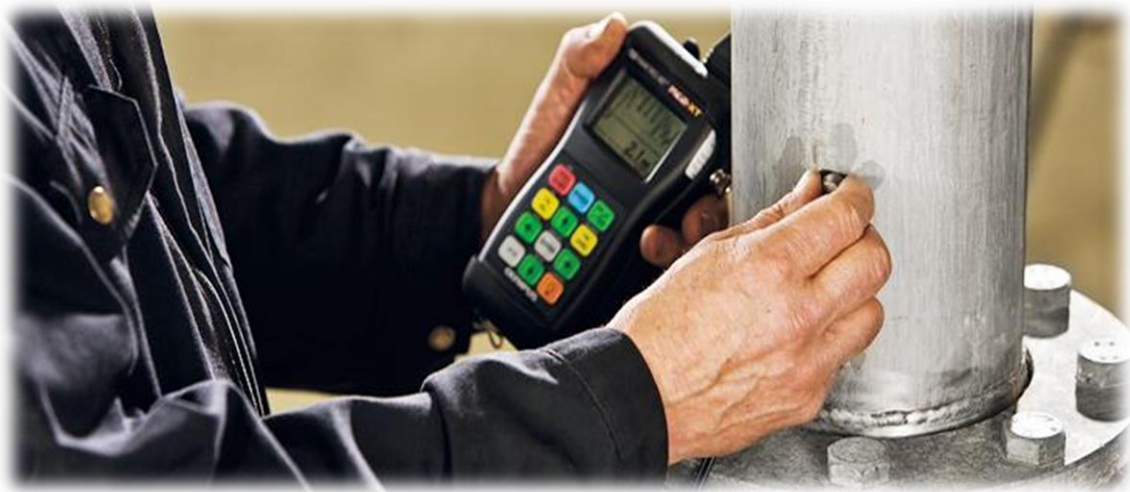
Σχήμα 1 – Μη Καταστροφικός Έλεγχος σε αγωγό [9]
