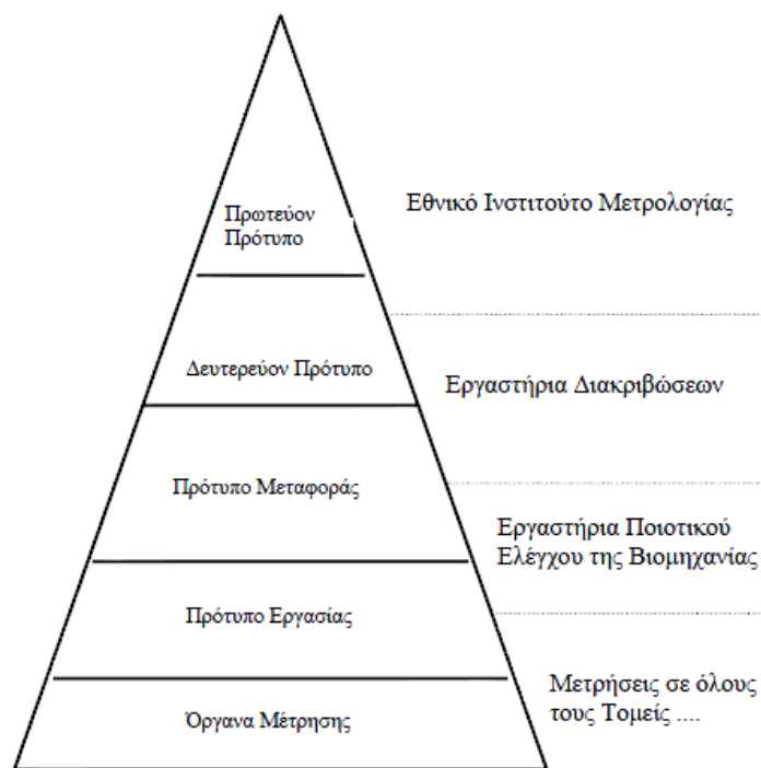
Σχήμα 13: Ιεράρχηση Προτύπων Μέτρησης σε Εθνικό Σύστημα Μετρολογίας [Πηγή: ΑΒΕΒΑΙΟΤΗΤΑ ΜΕΤΡΗΣΕΩΝ: Εκτίμηση - Υπολογισμός - Έκφραση, Γ. Ναβροζίδης, Χ.Μήτσας, Ε. Φλουδά, Μ. Αναγνώστου, Φ. Στέλε, Ελληνικό Ινστιτούτο Μετρολογίας]
