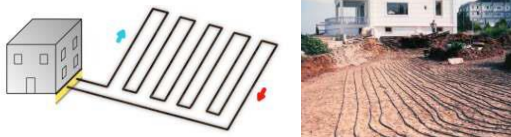
Σχήμα 3.4: Σύστημα οριζόντιου γεωεναλλάκτη απλής μορφής σε σειρά . (Βραχόπουλος κ.ά., 2015).
