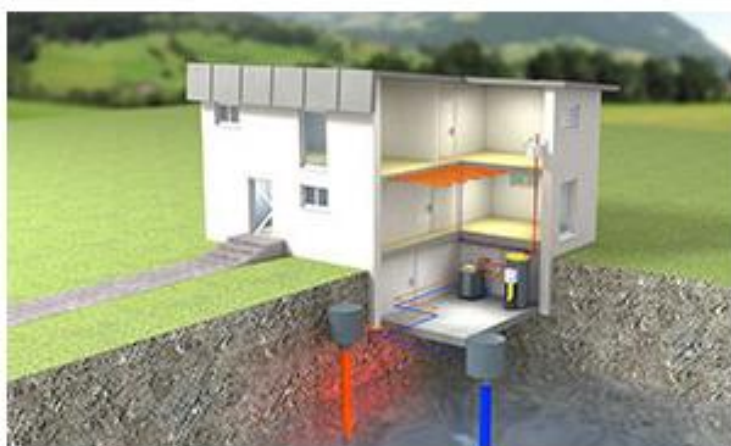
Σχήμα 3.10: Απεικόνιση ανοιχτού γεωθερμικού συστήματος ( www.stkaragiannis.gr ).
