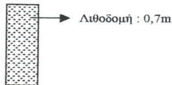
Σχήμα 1.7. Σκαρίφημα εξωτερικής τοιχοποιίας
