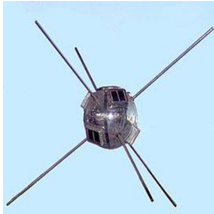
Εικόνα 3. Ο πρώτος τεχνητός δορυφόρος που χρησιμοποίησε την ηλεκτρική ενέργεια από Φ/Β σύστημα.
