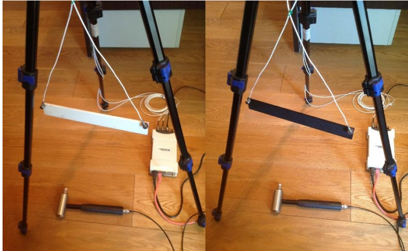
Εικόνα 6.9: Η πειραματική διάταξη που χρησιμοποιήθηκε. Στα αριστερά το λευκό δοκίμιο με χρήση του υλικού ABS-M30 και στα δεξιά με μαύρο χρώμα το δοκίμιο από υλικό PC-ABS.
