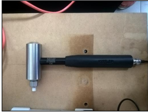
Εικόνα 6.8: Κρουστικό σφυρί με ειδική κεφαλή από καουτσούκ που χρησιμοποιήθηκε στο πείραμα.
