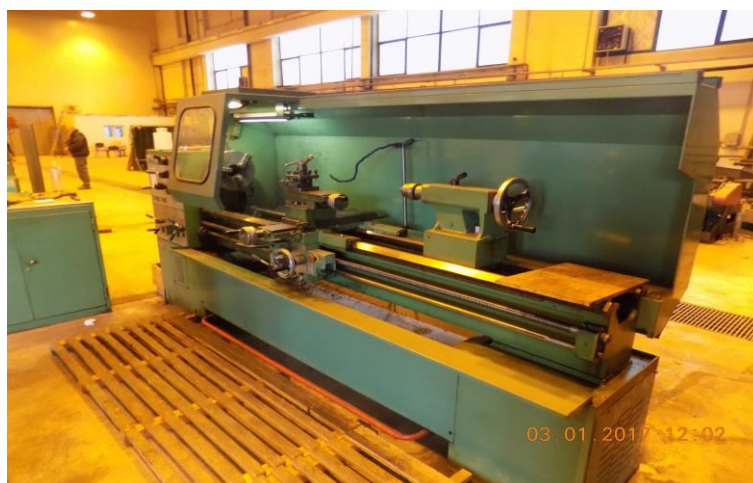
Εικόνα 31. Ξύλινο Πλαίσιο Μόνωσης σε Τόρνο
