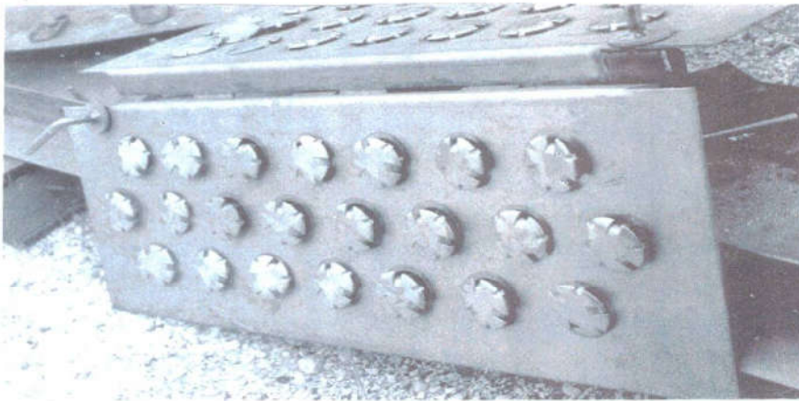
Σχήμα 2.10 Δίσκος αποστακτικής στήλης με κάψες (Διυλιστήριο E.K.O.) [1]
