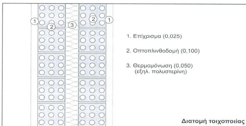
Σχήμα 3. Θερμομόνωση εξωτερικής τοιχοποιίας στον πυρήνα
