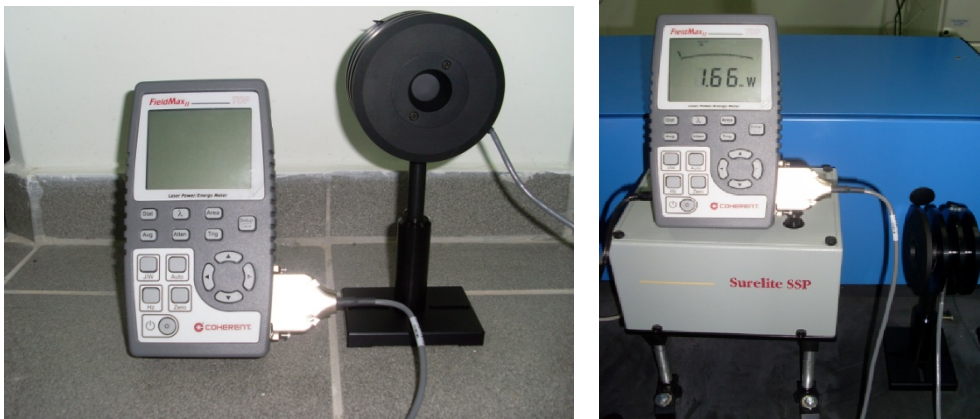
Σχήμα 2.11: Το power meter μαζί με τον αισθητήρα και η μέτρηση της ισχύος του παλμού
