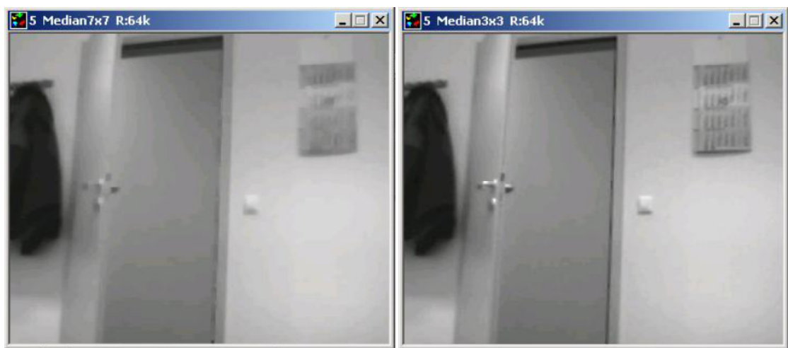
Σχήμα 3.4: Παραδείγματα με φίλτρο διάβρωσης (αριστερά) και με φίλτρο διαστολής (δεξιά)[3]
