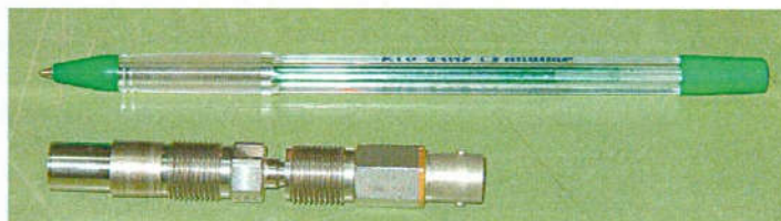
Σχήμα 2.2 Ο αισθητής πίεσης του ΕΕΘ μαζί με τον προσαρμογέα καλωδίου
