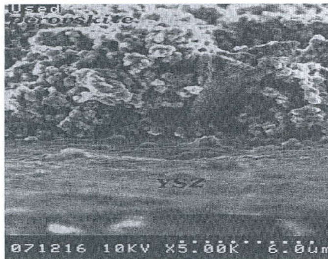
Σχήμα 4.2: Τυπικό μικρογράφημα σάρωσης (S.E.M.) της διεπιφάνειας LSCF|YSZ
