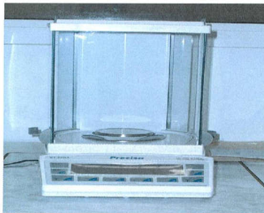
Εικόνα 23. Ζυγός ακριβείας (4 δεκαδικών) της εταιρίας Precisa, μοντέλο XT220A. Φωτογραφία από το Εργαστήριο Τεχνολογίας Περιβάλλοντος, Π.Δ.Μ.
