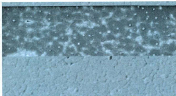
Εικόνα 20. Σύγκριση δυο τεχνικών της ηλεκτρονικής μικροσκοπίας (SEM) [22]. Επάνω: Ανάλυση σύστασης μέσω οπισθοσκεδαζόμενων ηλεκτρονίων. Κάτω: Ανάλυση μορφολογίας μέσω δευτερευόντων ηλεκτρονίων.
