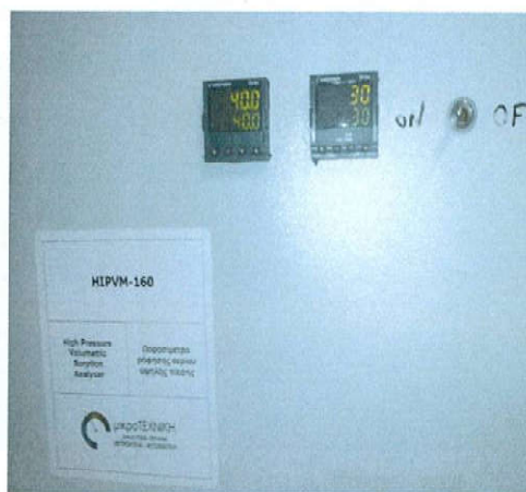
Εικόνα 34.:Εξωτερική όψη ποροσίμετρου και σε μεγέθυνση δίπλα οι ενδείξεις πίεσης και θερμοκρασίας.
