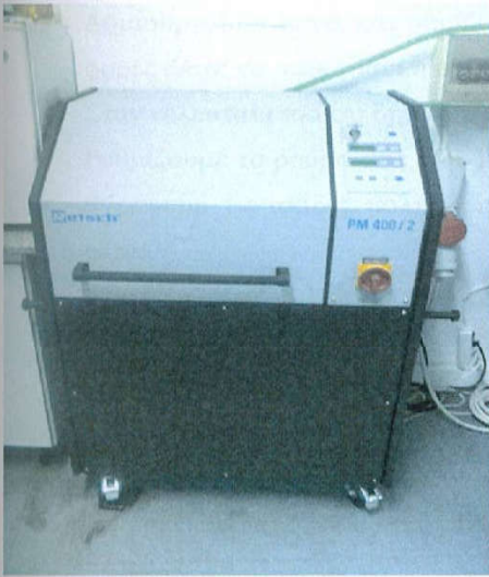
Εικόνα 31.: Ειδική διάταξη πλανητικού σφαιρόμυλου υψηλής ενέργειας
