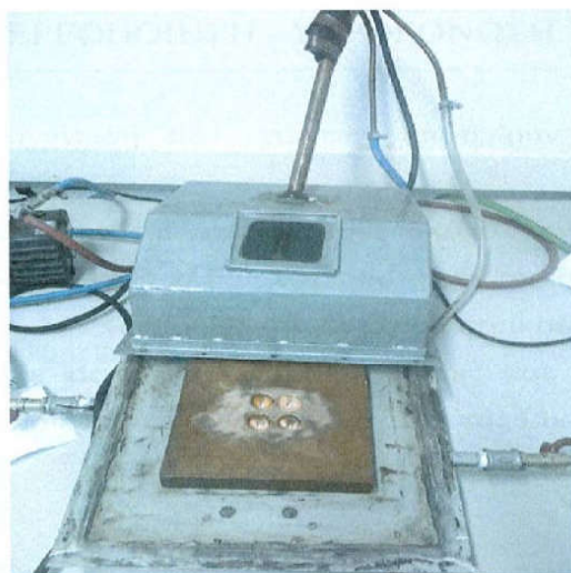
Εικόνα 33.: Εσωτερικό πολυσυσκευής τήξης βολταϊκού τόξου για απότομη στερεοποίηση λιωμένου κράματος
