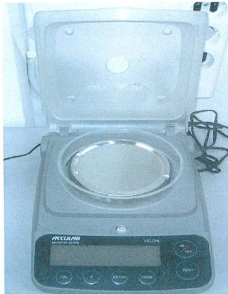
Εικόνα 29.: Ζυγός ακριβείας (4 δεκαδικών) της εταιρίας Acculab, SARTORIUS GROUP GERMANY μοντέλο VIC-123, max=120gr. Φωτογραφία από το Εργαστήριο Τεχνολογίας Περιβάλλοντος, Π.Δ.Μ.
