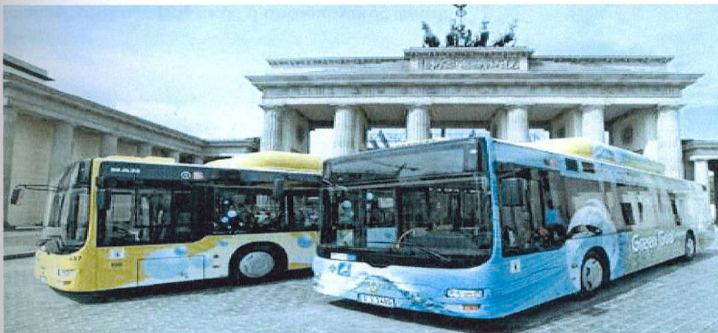
Εικόνα 9.: Αστικά επιβατικά λεωφορεία της εταιρίας MAN κινούμενα με MEK υδρογόνου, τα οποία κυκλοφόρησαν τον Ιούνιο του 2006 στο Βερολίνο της Γερμανίας, ως μέρος του ευρωπαϊκού προγράμματος HyFLEET:CUTE [22].
