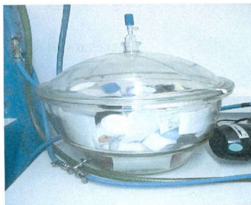
Εικόνα 28.:Κώδωνας για τη φύλαξη των πρώτων υλών σε συνθήκες αδρανούς ατμόσφαιρας
