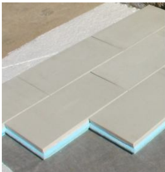
Εικόνα iv 2. Θερμομονωτικά πλακίδια για τη μόνωση οροφής.
