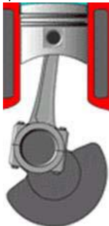
Εικόνα 2.9.4.1: Παράδειγμα διωστήρα συνδεδεμένου με το έμβολο
