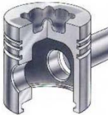
Εικόνα 2.17.2: Τομή κελύφους θαλάμου καύσης
