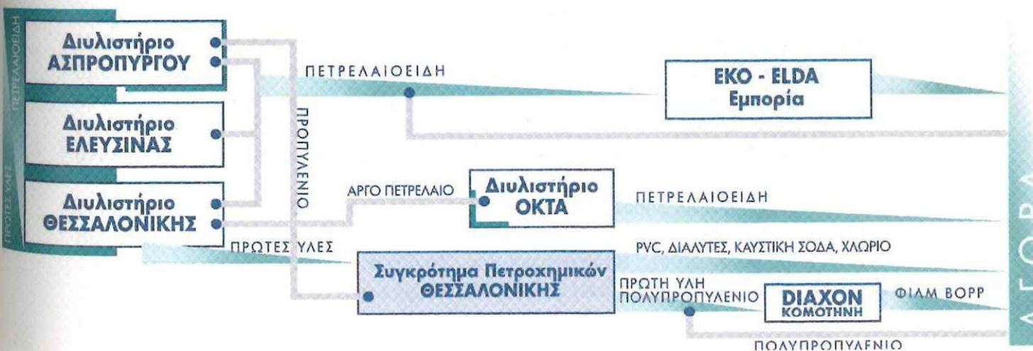
Διάγραμμα 23. Ενοποιημένο σχήμα λειτουργίας του ομίλου
