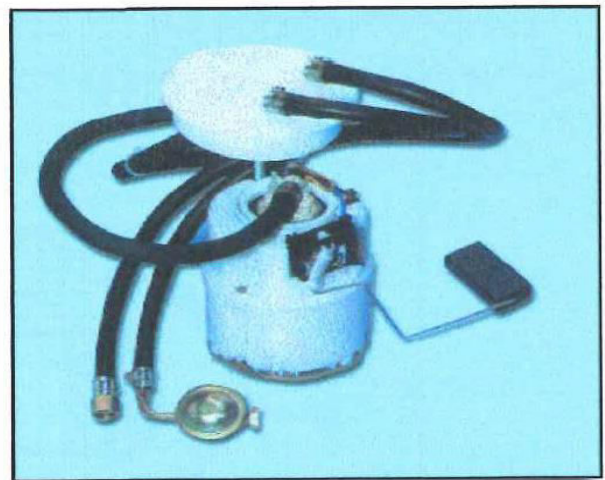
Σχήμα 4-7 : Εμβαπτιζόμενη αντλία με δοχείο σταθεροποίησης
