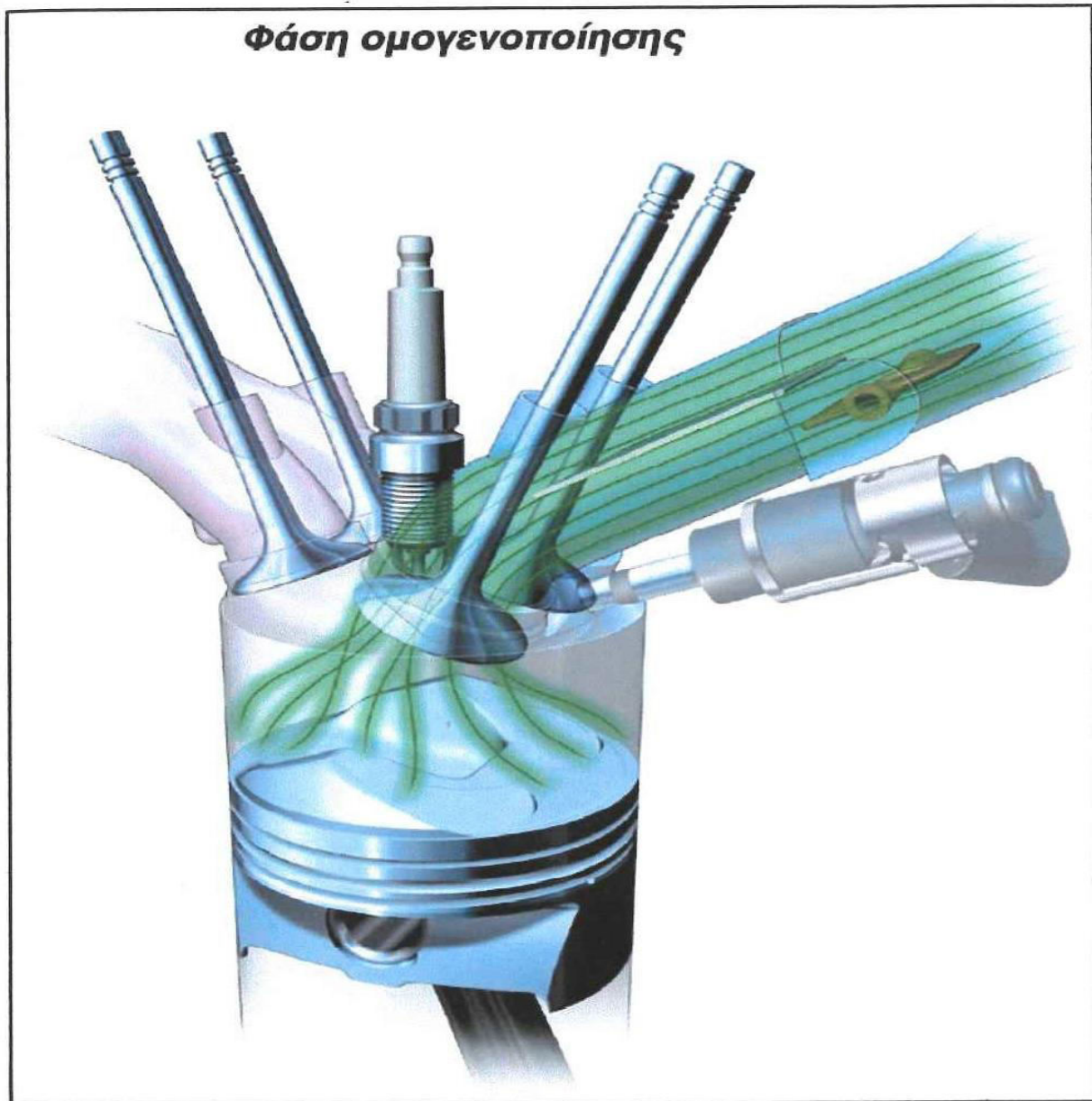
Σχήμα 7-10 : στις υψηλές στροφές (φάση ομογενοποίησης), η κλίση της πεταλούδας επιτρέπει την πλήρη παροχή του αέρα, λίγο πριν από τη συμπίεση
