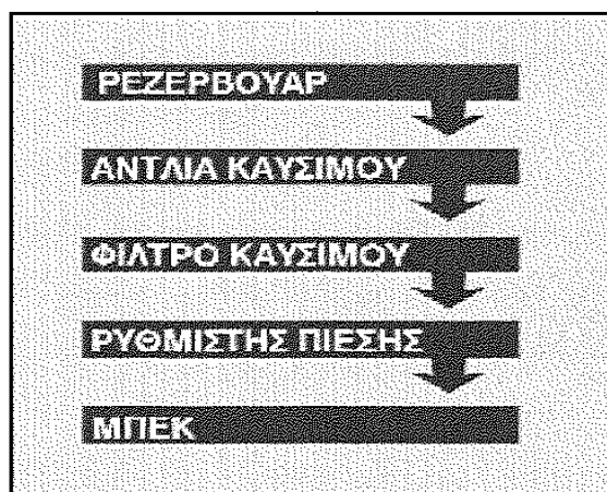
Σχήμα 4-1: Διάγραμμα ροής του συστήματος τροφοδοσίας
