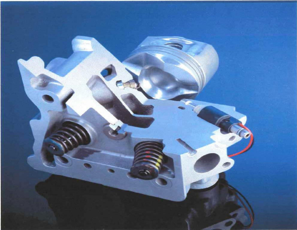
Σχήμα 7-6 : Τομή της κυλινδροκεφαλής ενός κινητήρα άμεσου ψεκασμού(φαίνεται καθαρά η ειδική διαμόρφωση της κεφαλής του εμβόλου, η θέση του σπινθηριστή αλλά και τον εγχυτήρα)
