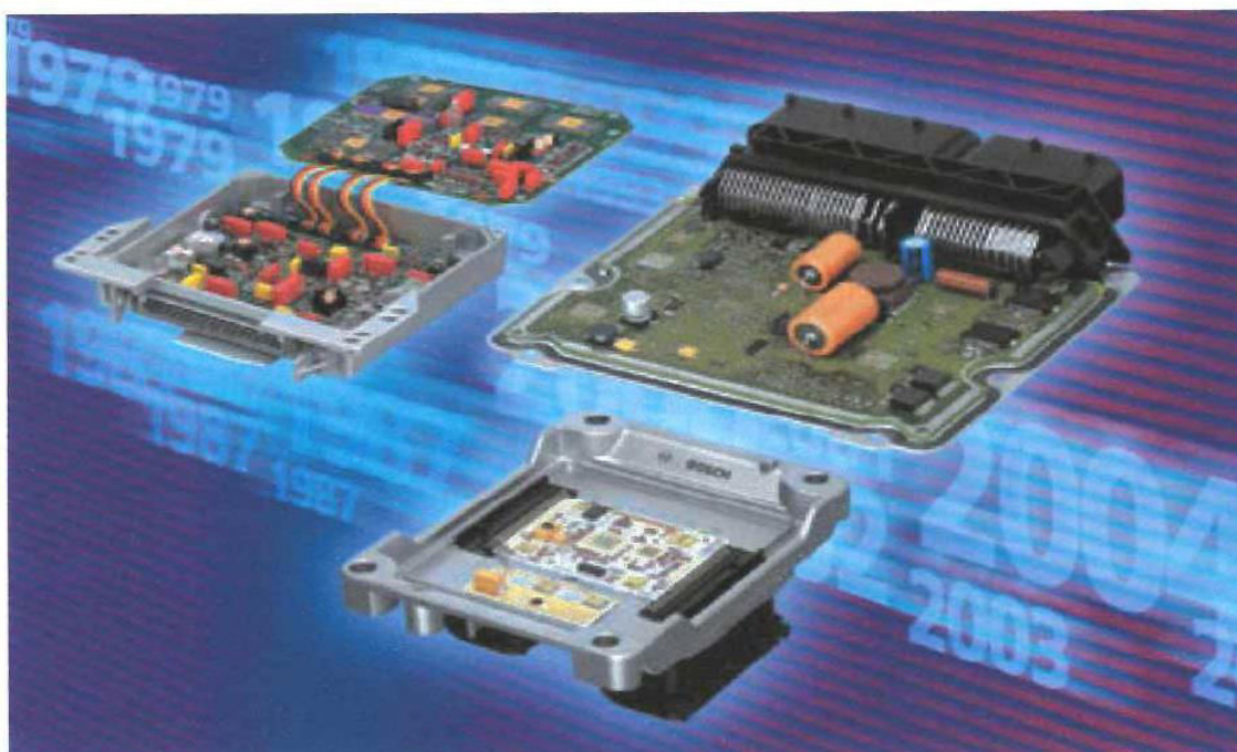
Σχήμα 4-31 : Εσωτερική όψη ΗΜΕ
