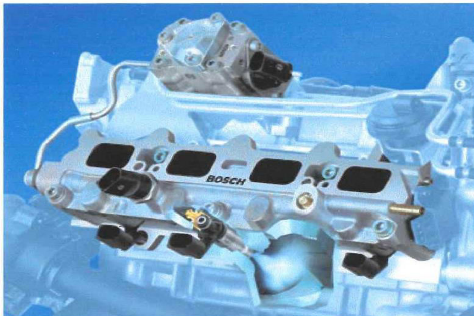
Σχήμα 7-17 : Ηλεκτρονικό σύστημα άμεσου ψεκασμού βενζίνης
