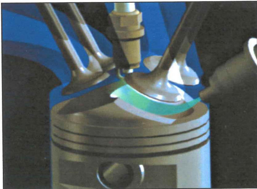
Σχήμα 7-24 : Σε μικρά φορτία το καύσιμο ψεκάζεται στο τέλος του χρόνου συμπίεσης, όπως σε όλους τους κινητήρες άμεσου ψεκασμού
