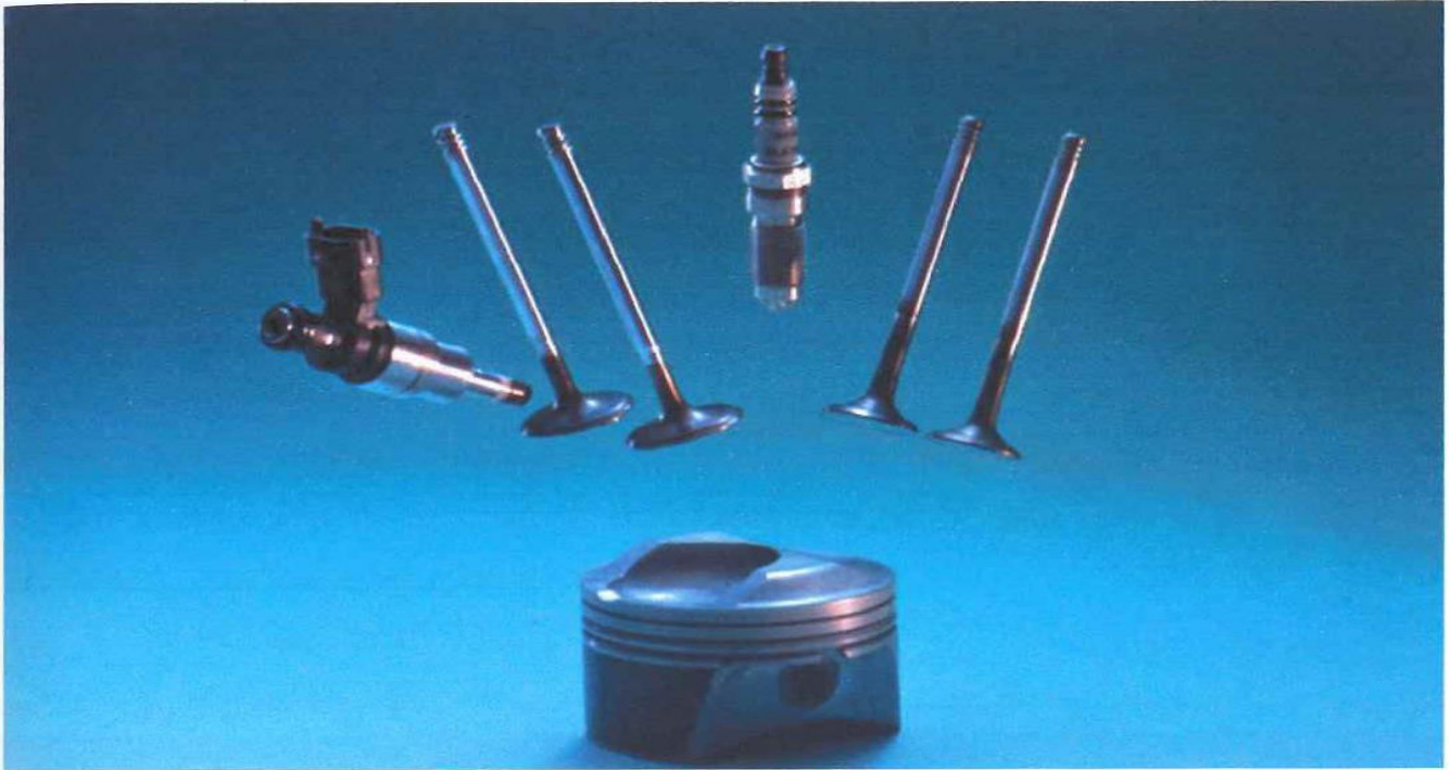
Σχήμα 7-2 : Φωτογραφία με διάταξη στο χώρο του εμβόλου, των βαλβίδων , του εγχυτήρα και του σπινθηριστή
